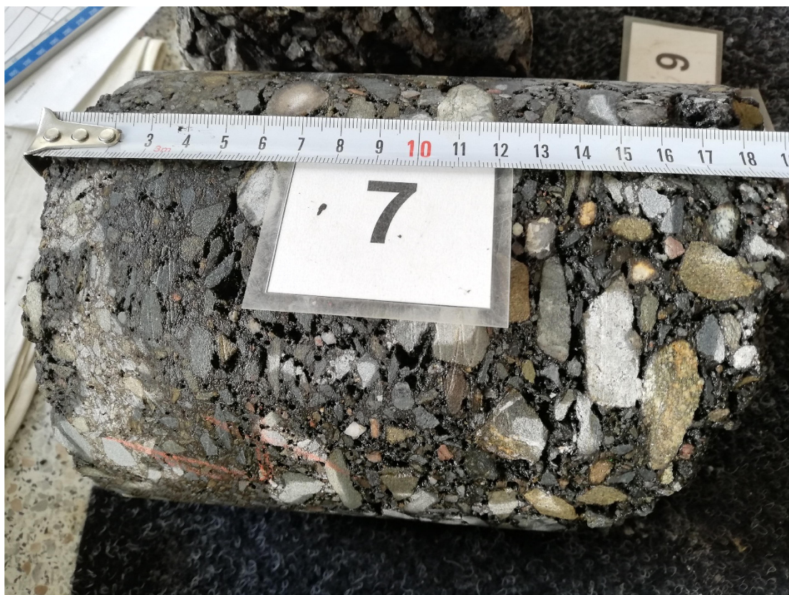
Obr. 24 AC vývrt JV7
