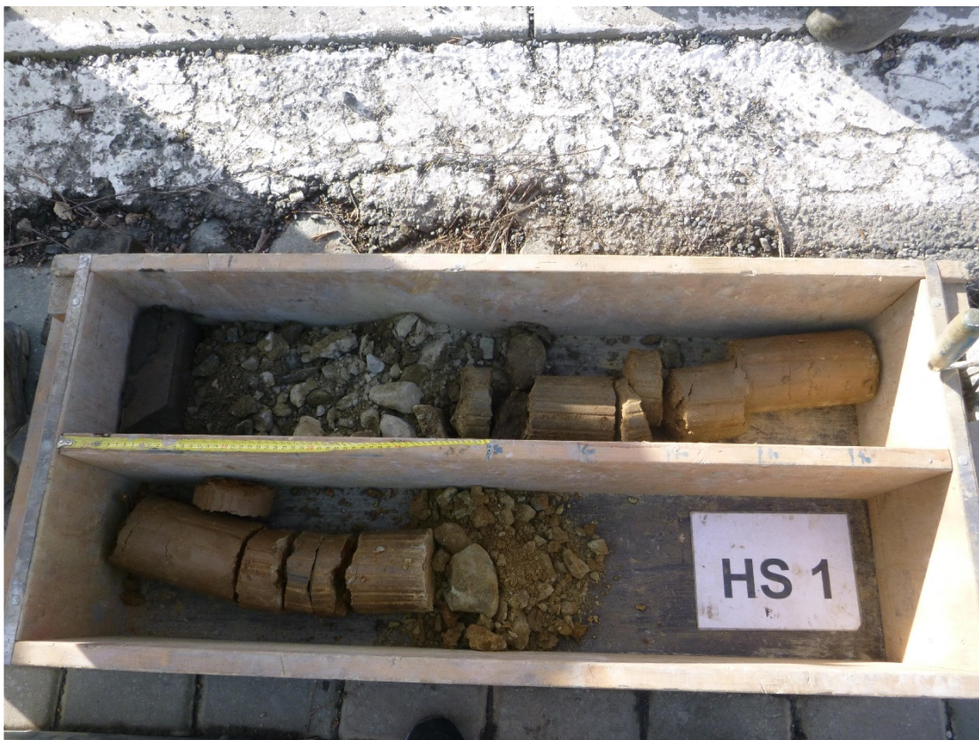
Obr. 4 Vzorkovnice hloubené sondy HS1
