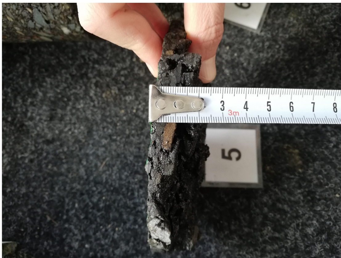
Obr. 22 AC vývrt JV5
