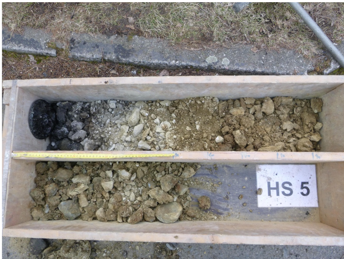
Obr. 12 Vzorkovnice hloubené sondy HS5
