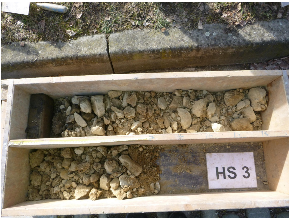
Obr. 8 Vzorkovnice hloubené sondy HS3
