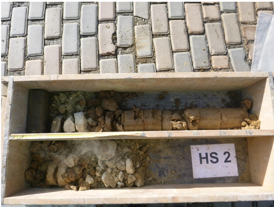
Obr. 6 Vzorkovnice hloubené sondy HS2
