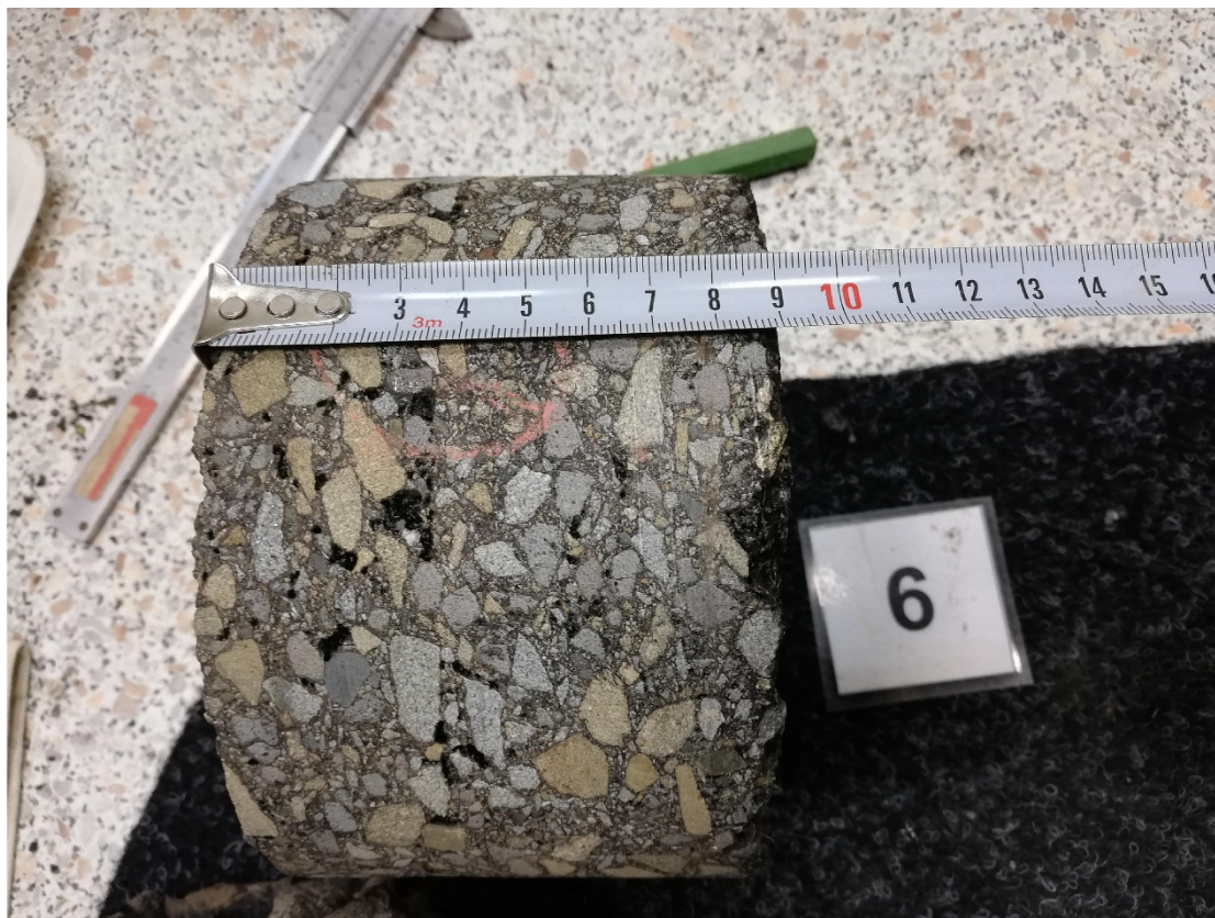
Obr. 23 AC vývrt JV6
