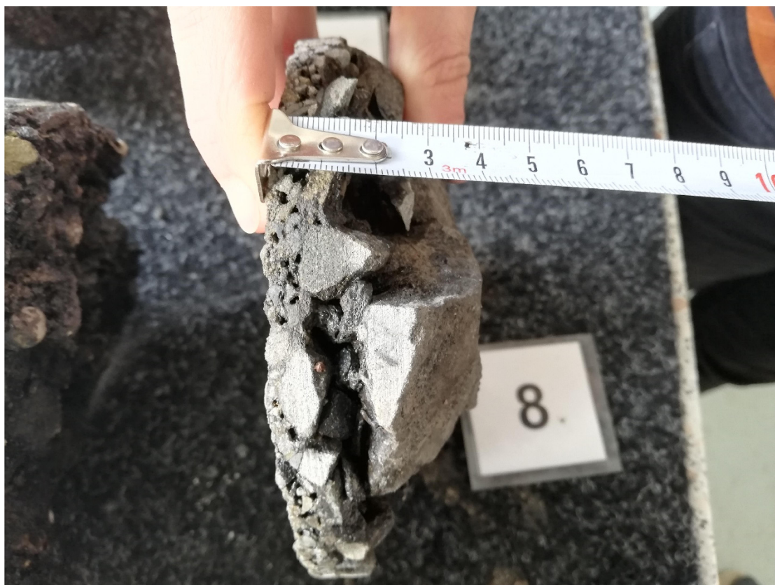
Obr. 25 AC vývrt JV8
