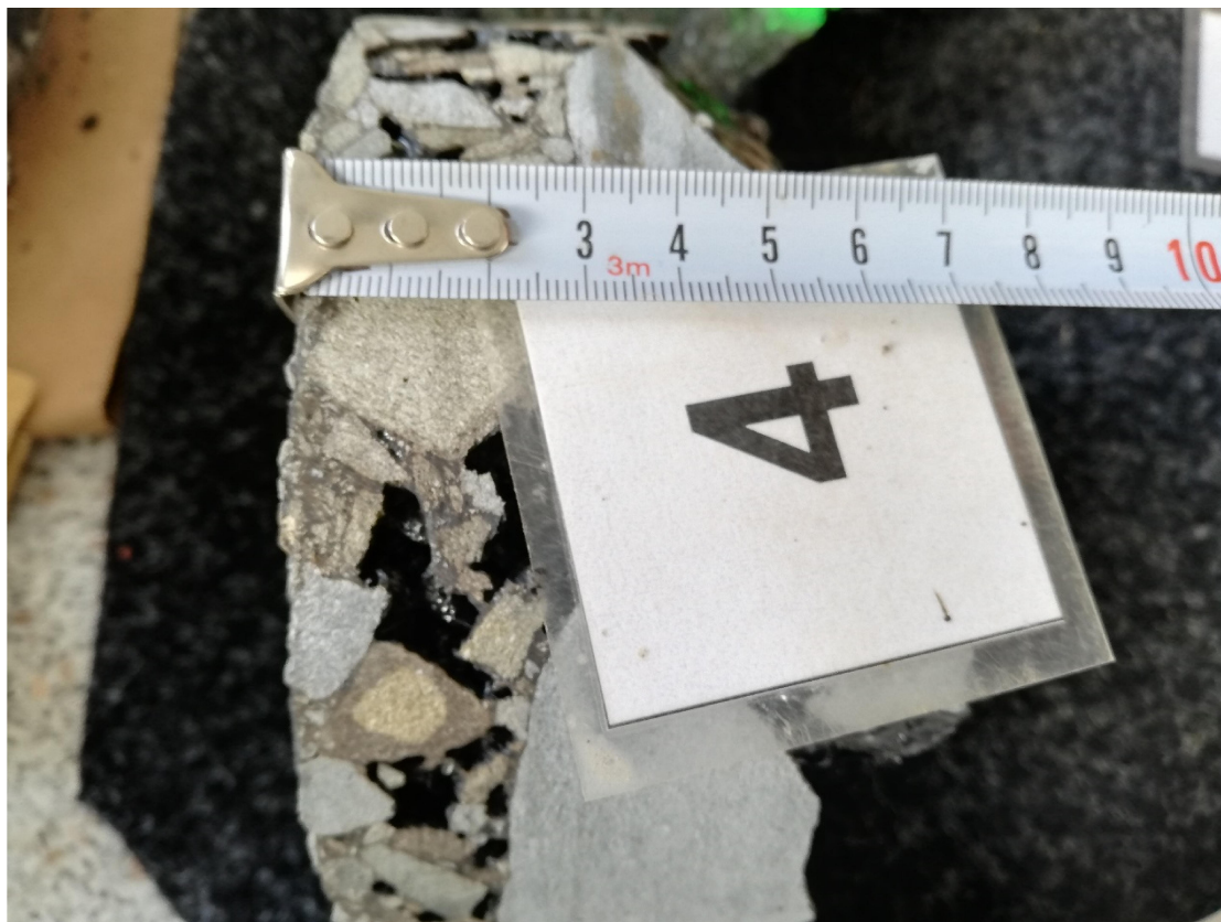
Obr. 21 AC vývrt JV4
