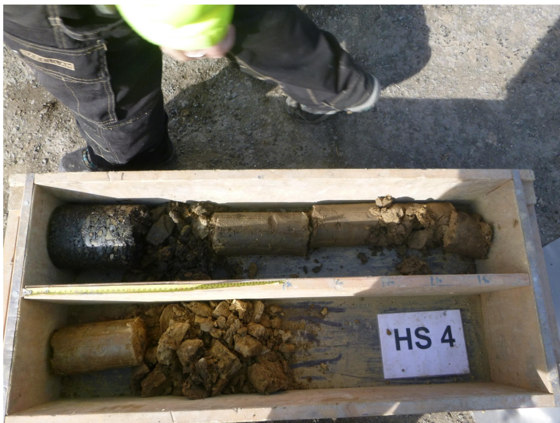
Obr. 10 Vzorkovnice hloubené sondy HS4
