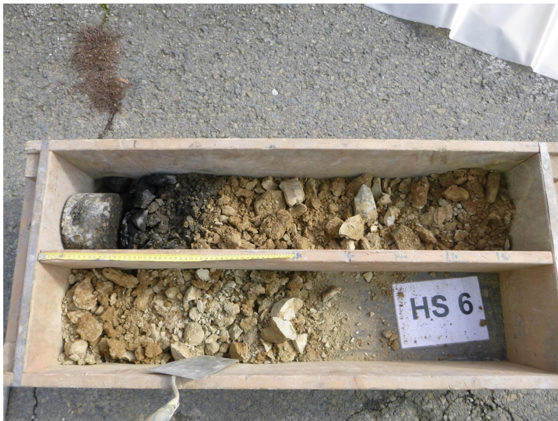
Obr. 14 Vzorkovnice hloubené sondy HS6
