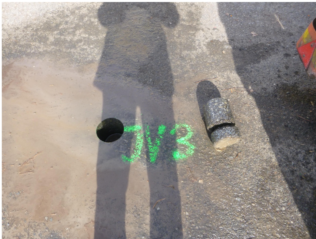
Obr. 20 Pohled na jádrový vrt JV9 (přeznačeno z JV3)
