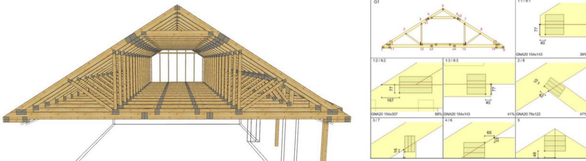
Rys. 3 Przykładowe rozwiązanie konstrukcji dachowej oraz sposób zacięcia elementów drewnianych.
