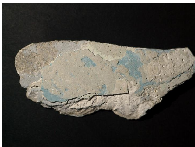
Obr.č. 1: povrch vrstiev modrých náterov na omietke, viditeľné sú tri modro sfarbené náterové vrstvy: najspodnejšia – na kontakte s omietkou náter I, stredný modrozelený II, vrchný modrý – III.
