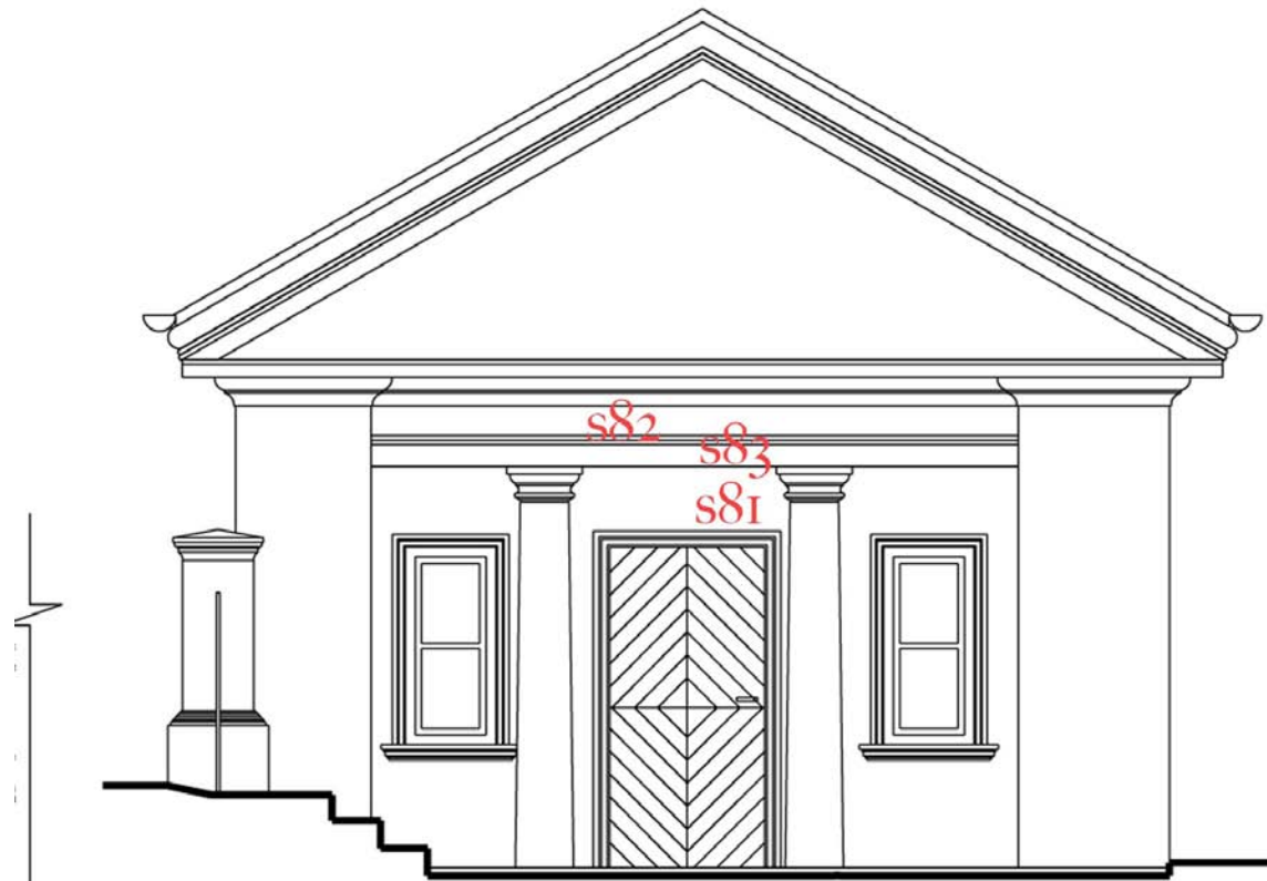
Situovanie sond na fasáde vrátnice.
