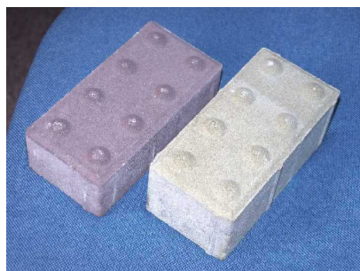
Obr. 1 Betonová zámková dlažba s výstupky pravidelného tvaru
