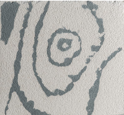
Materiálový vzorek provedení sgrafita (50x50cm) kombinace dvou omítek bez proškrabávání za sucha.
