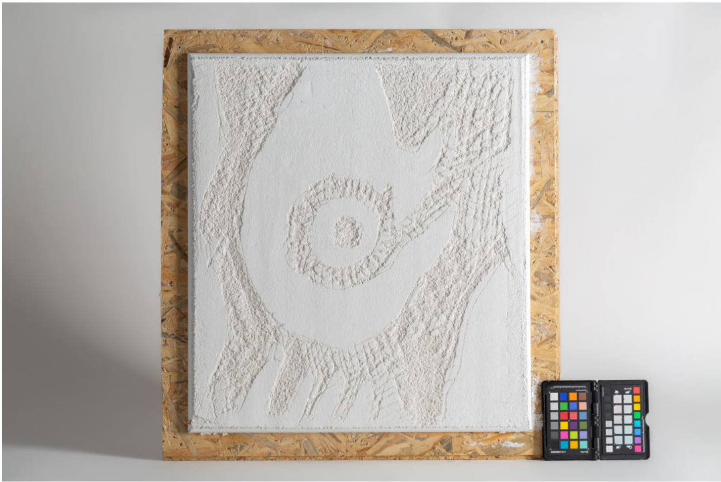
Ověření vzorků ztvárnění výtvarného motivu 1 - navržené řešení - kontrast hlazených a škrábaných ploch - při realizaci dále upřesněno
