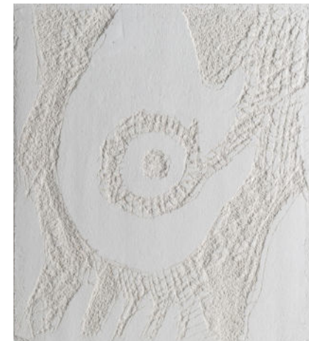
Materiálový vzorek provedení sgrafita (50x50cm) kombinace hladkého a proškrabovaného povrchu omítky.
