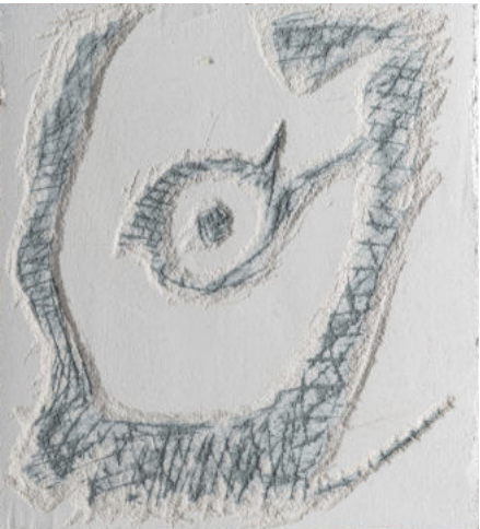
Materiálový vzorek provedení sgrafita (50x50cm) kombinace dvou proškrabovaných omítek ve dvou barvách.
