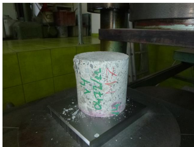
Příklad pohled na porušený vzorek V4 při hodnotě 38,2 MPa.
