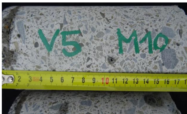
Detailní pohled na jádro vývrty V5. Zvýšená pórovitost při povrchu.
