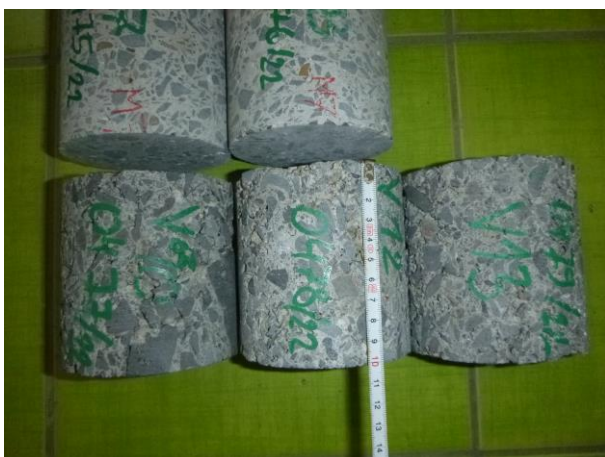
Pohled na upravené vzorky V10, V12 a V13 pro destruktivní zkoušku pevnosti betonu v tlaku.
