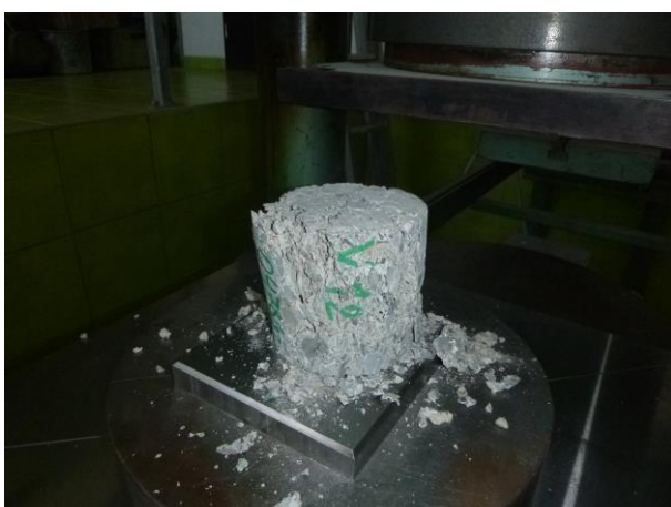
Pohled na porušený vzorek V12 při hodnotě krychelné pevnosti v tlaku 9,4 MPa.
