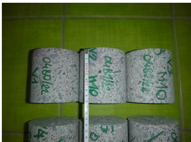
Pohled na upravené vzorky pro zkoušku pevnosti betonu v tlaku.
