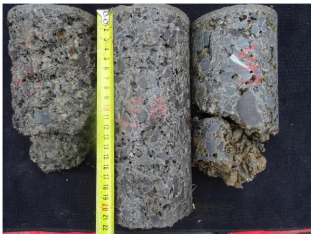
Pohled na vývrt V9, V10 a V11 z OP1. Velmi vysoká pórovitost zrn kameniva, absence cementového tmele, malá objemová hmotnost.
