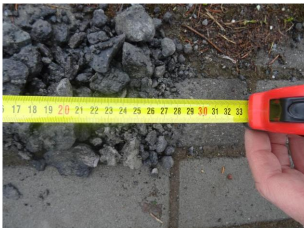
Štěrkopískový násyp frakce 0/32 mm.
