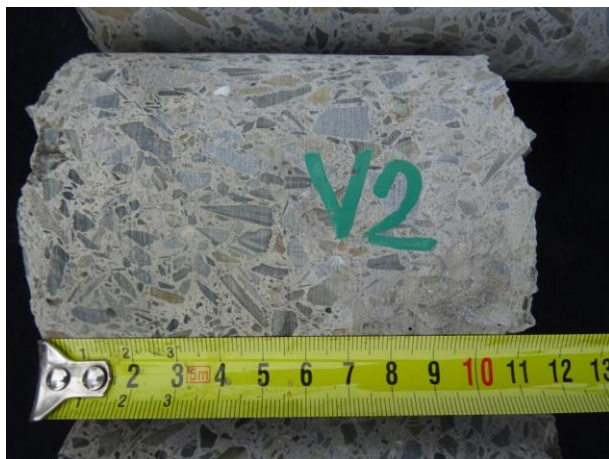
Detailní pohled na jádro vývrtu V2.
