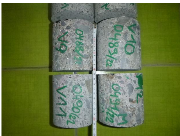
Pohled na upravené vývrty pro následnou zkoušku pevnost betonu v tlaku.
