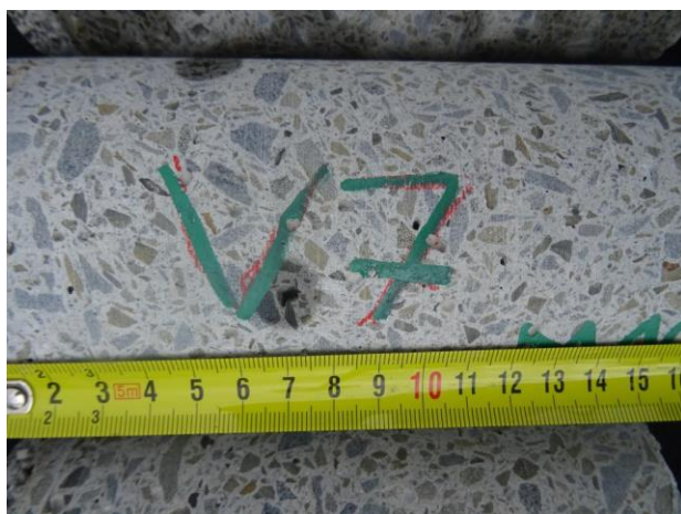
Detailní pohled na jádro vývrty V7.
