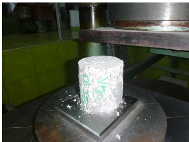
Pohled na porušený vzorek V10 při hodnotě krychelné pevnosti v tlaku 12,3 MPa.
