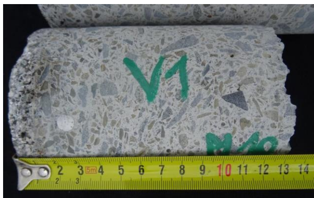
Detailní pohled na jádro vývrty V1. Zvýšená pórovitost při povrchu.
