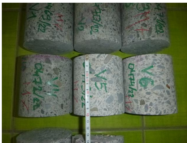
Celkový pohled na upravené vývrty pro zkoušku.
