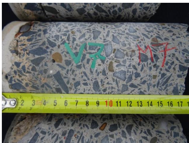
Detailní pohled na jádro vývrtu V7.
