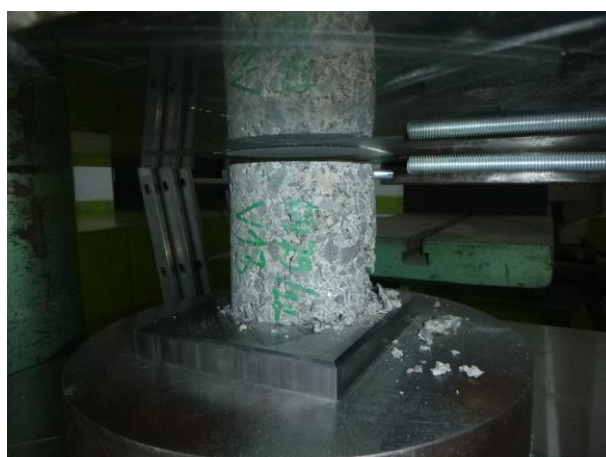
Pohled na porušený vzorek V13 při hodnotě krychelné pevnosti v tlaku 14,6 MPa.
