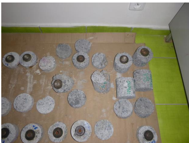
Pohled na nalepené terče na vývrtech v laboratoři.
