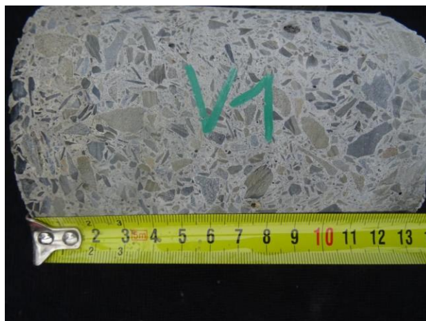
Detailní pohled na jádro vývrtu V1.
