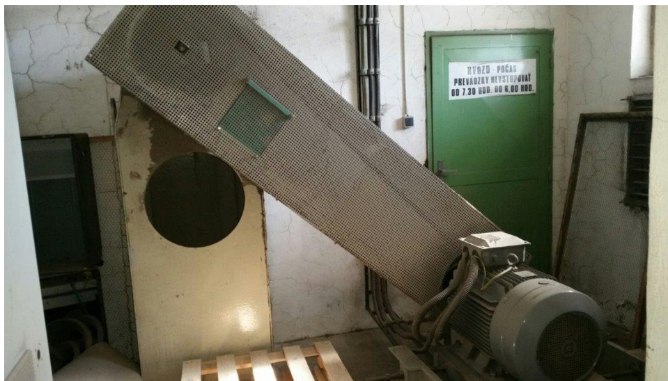
Obrázok č.16.: Hvozďový ventilátor na remeňový prevod
