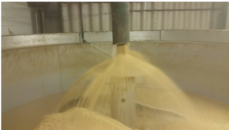
Obrázok č.5.: Horná časť mokrého náduvníka - naskladňovanie zastaranými dopravnými cestami
