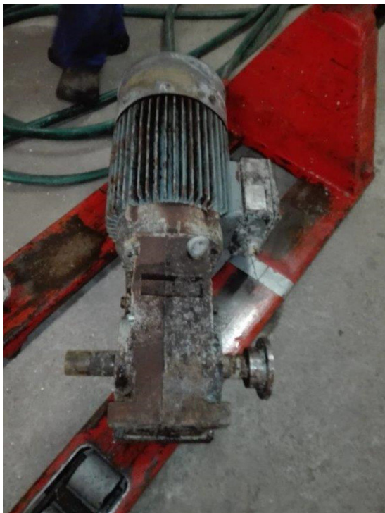
Obrázok č. 10.: Zastaraná, opotrebovaná a skorodovaná prevodovka a jej častá oprava
