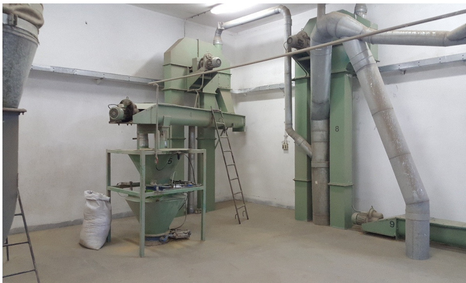
Obrázok č. 1.: Existujúce zariadenia pre príjem jačmeňa (vertikálna a horizontálna doprava s prietokovou váhou).
