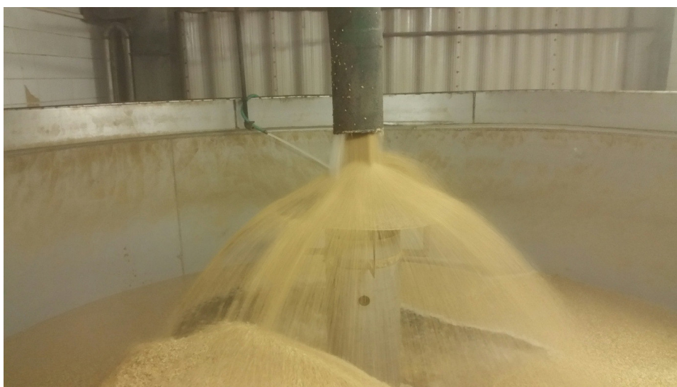
Obrázok č.23.: Naskladňovanie jačmeňa do náduvníka a rozptýlený prach
