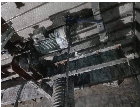
Obrázok č.13.: Zastaraná elektroprevodovka pod lieskou klíčiacej skrine
