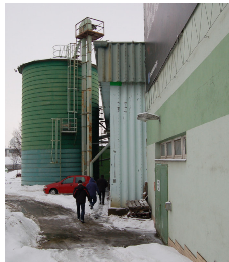
Obrázok č.7.: Vonkajší zásobník na uskladnenie sladu so zastaranými dopravnými cestami
