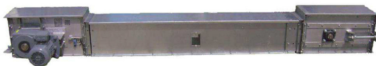
Obrázok č.24.: Nový moderný reťazový dopravník na dopravu sladu
