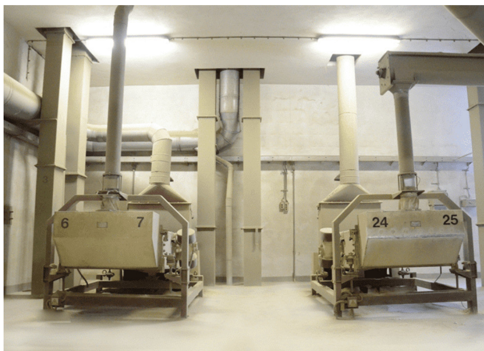
Obrázok č.2.: Existujúca predčistiareň jačmeňa s výkonom 15t/h, označená číslami 6 a 7. Číslami 24 a 25 je označené zariadenie pre dočistenie jačmeňa pred ďalším použitím.
