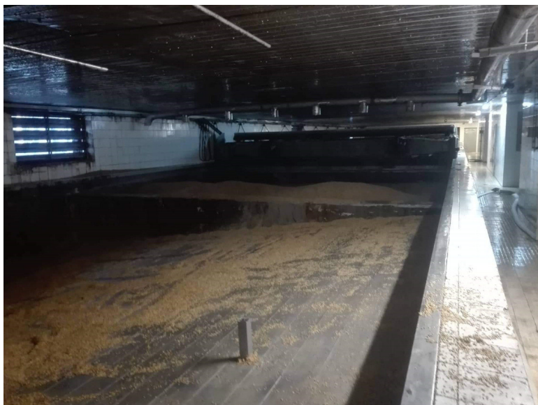
Obrázok č.14.: Skríženie liesky klíčiacej skrine spôsobené zastaranými a opotrebovanými zariadeniami a súčiastkami
