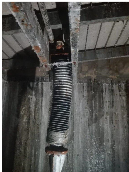
Obrázok č.11.: Skríženie trapézovej skrutky spôsobené opotrebovanosťou závitů a nesynchronným pohybom zastaraných prevodoviek
