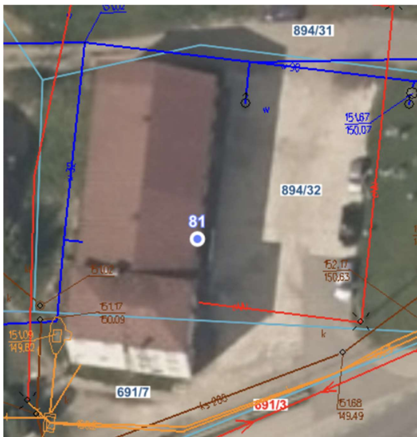
Fotografia 1 Lokalizacja obiektu i uzbrojenie terenu
