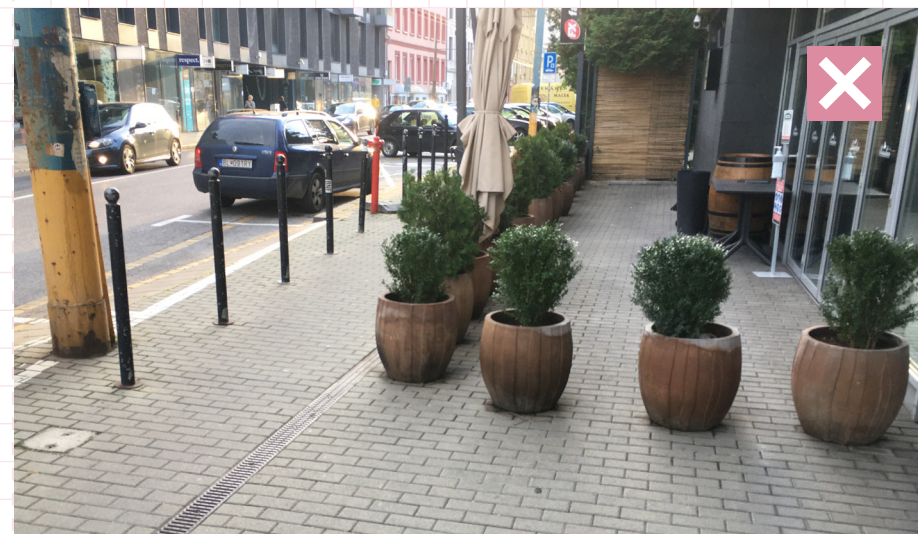
07 Príklad nevhodného ohradenia terasy súvislým pásom kvetináčov bez priestorového delenia a bez zachovania minimálnej šírky prechodu medzi stĺpkami a kvetináčmi. Bratislava, Dunajská ulica
