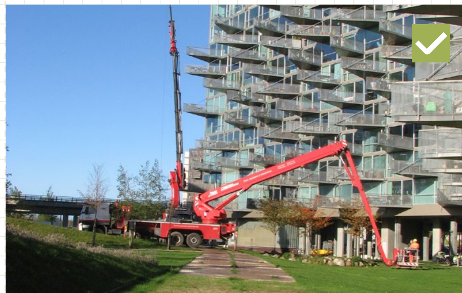
12 Prejazd vozidla po oceľových platniach, záťaž je roznášaná na väčšiu plochu. Kodaň, Dánsko
