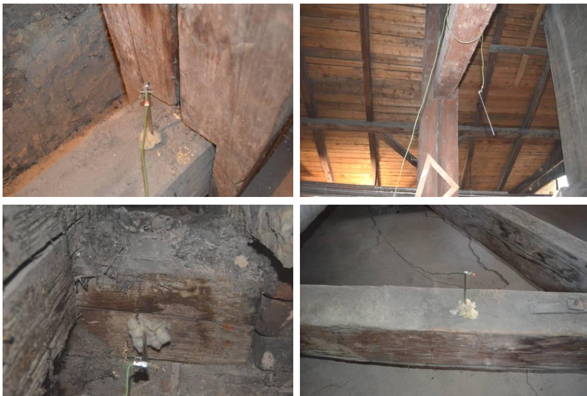
Obr. 6 Ukázka termoelektrických snímačů měřících teplotu dřevěných prvků konstrukce
