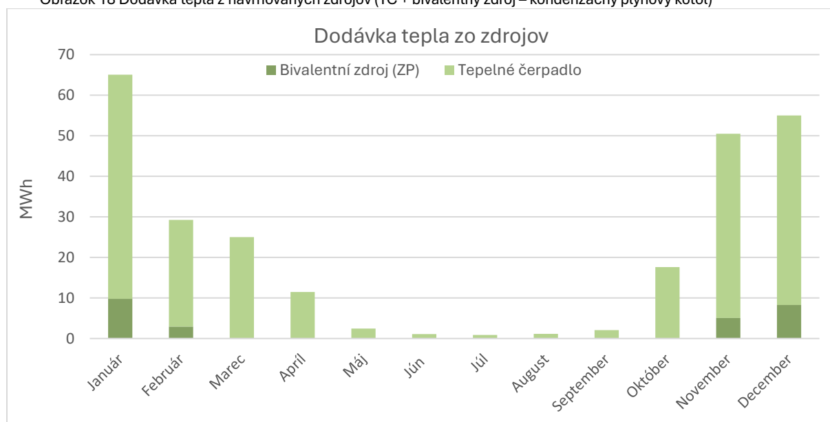
Obrázok 18 Dodávka tepla z navrhovaných zdrojov (TČ + bivalentný zdroj – kondenzačný plynový kotol)
