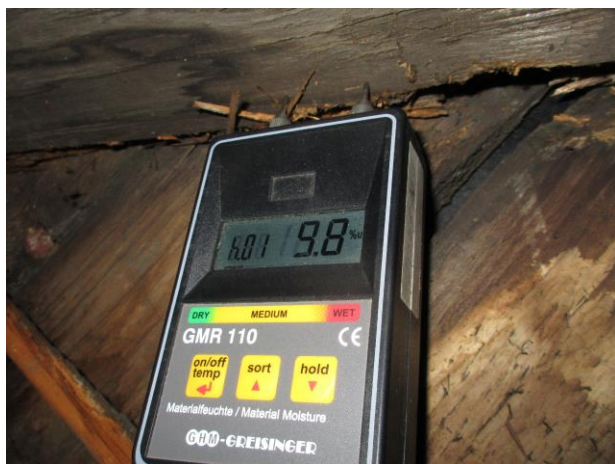
Foto 59 Zóna C/2.úsek/P: Krokva úžľabová ( w = 9,8\% ) (PS: Krokva v minulosti poškodená hnilobou)
