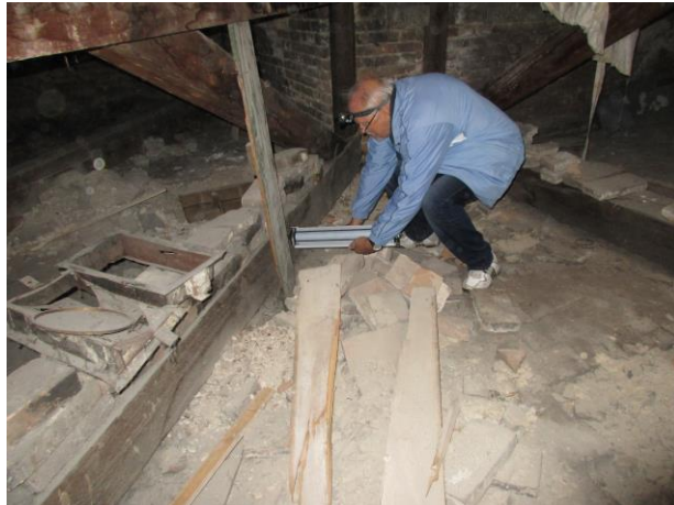
Foto 61 a 62 Zóna A/2.úsek/L: Trám úžľabový (61 = vrt RK1 ~ 0,5 m od pätky; 62 = vrt RK2 ~ 1,4 m od pätky)
