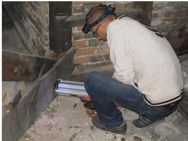
Foto 61 a 62 Zóna A/2.úsek/L: Trám úžľabový (61 = vrt RK1 ~ 0,5 m od pätky; 62 = vrt RK2 ~ 1,4 m od pätky)
