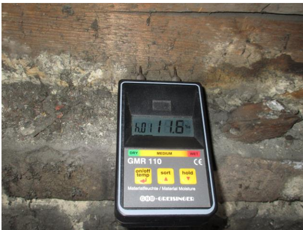
Foto 60 Zóna C/2.úsek/P: Pomúrnicka ( w = 11,6\% )
