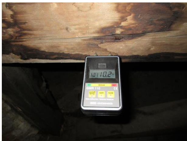
Foto 55 Zóna A/5.úsek/L: Klieština ( w = 10,2\% )
