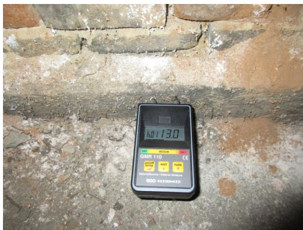
Foto 56 Zóna A/5.úsek/L: Pomúrnicka spodná ( w = 13\% )
