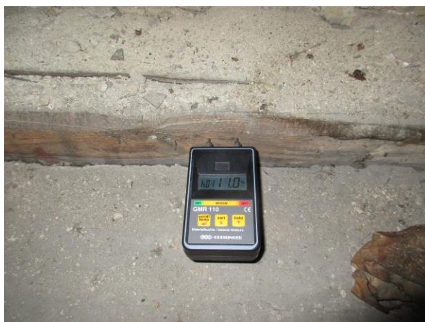
Foto 57 Zóna B/3.úsek/P: Pomúrnicka ( w = 11\% )
