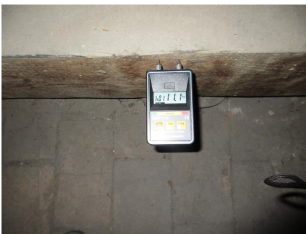
Foto 58 Zóna B/4.úsek/L: Väzný trám ( w = 11,1\% )
