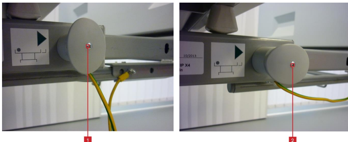
Obr. 25 Aretační/bezpečnostní zámek zajišťující polohu prodloužení lůžka.
