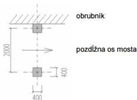
Obrázok 2 Schéma zaťaženia LM2
