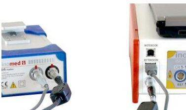
Obrázok 5-7: Pripojenie na ďalšiu hlavnú skrinku ISIS
