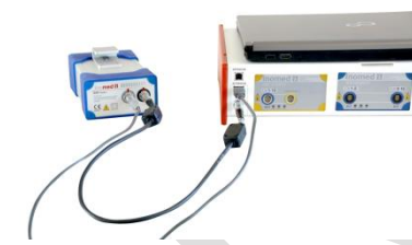
Obrázok 5-8: Pripojenie na ďalšiu hlavnú skrinku ISIS
