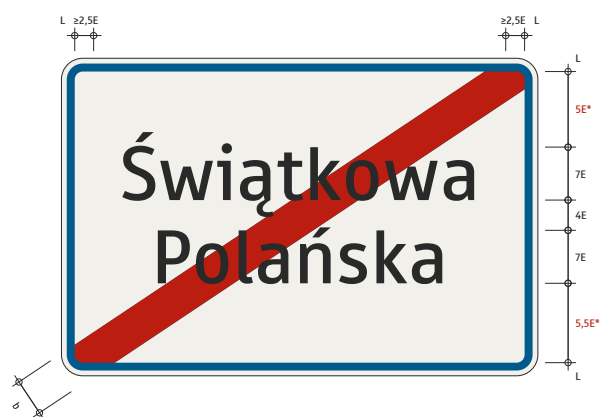
veľkosť 2: E=15 mm, b=70 mm veľkosť 3: E=20 mm, b=98 mm
