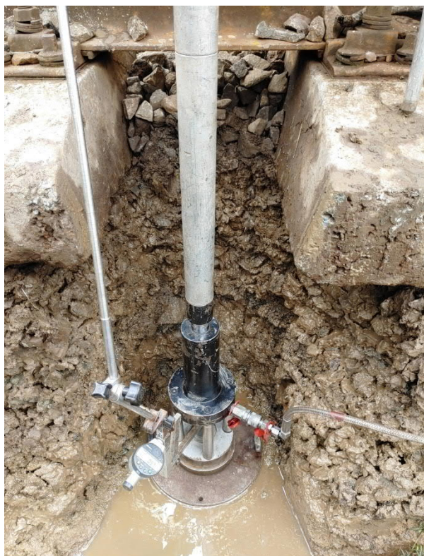
Obrázok 9 Pohľad na zatopenú kopanú sondu pre statickú zaťažovaciu skúšku ZS-2/11. Voda priteká na rozhraní koľajového kameniva a podložných nepriepustných vrstiev zemnej pláne.
