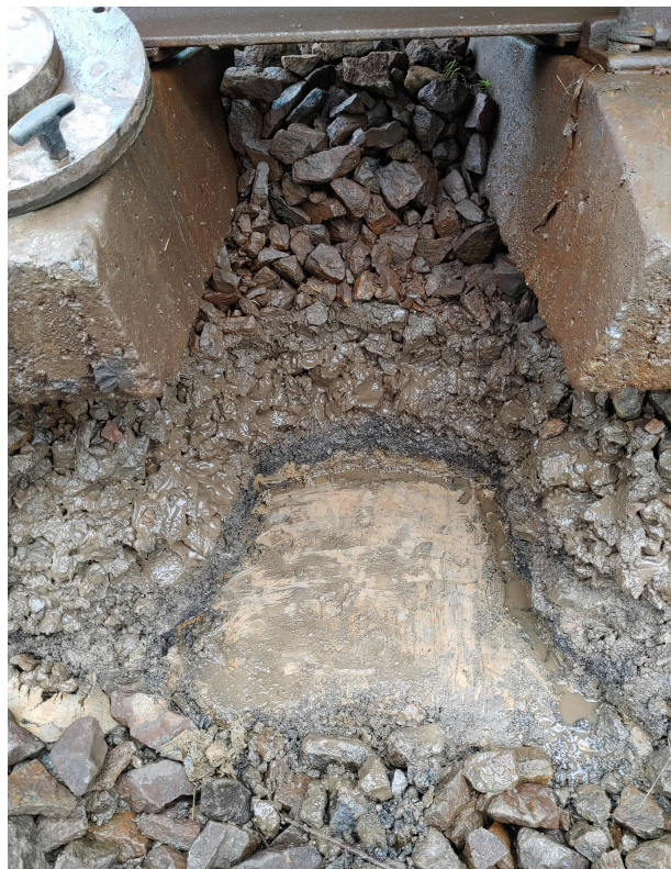
Obrázok 5 Pohľad na do kopanej sondy pre statickú zaťažovaciu skúšku SZS-05 s charakteristickým zložením konštrukčných vrstiev, kde sa pod vrstvou koľajového kameniva nachádza vrstva ílu strednej plasticity
