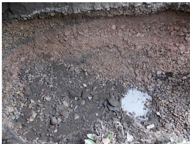
Obrázok 7 Štrkodrva v kopanej sonde pod vrstvou betónu
