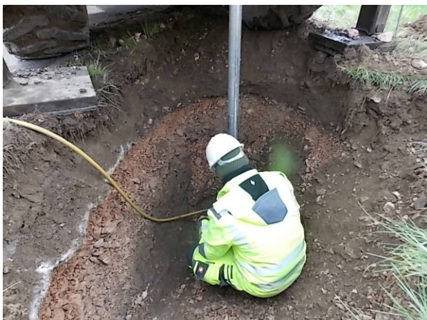
Obrázok 7 Realizácia statickej zaťažovacej skúšky v úrovni budúcej zemnej pláne
