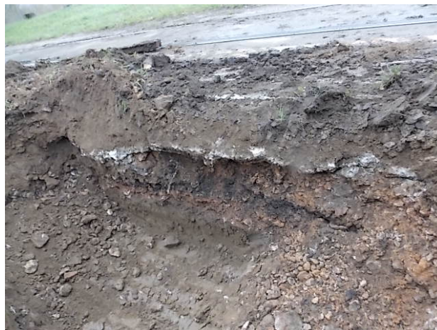
Obrázok 6 Vrstva betónu zistená v kopaných sondách
