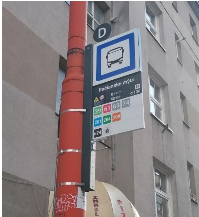
Obrázok 133_Příklad označníka na existujícíom stĺpe - farebnosť pásov nezodpovedá požadovanej farebnosti RAL 7016
