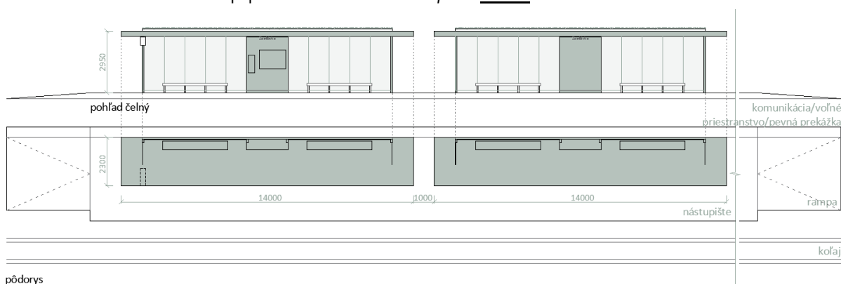
Obrázok 65_Umiestnenie MFP na jednostrannom nástupišti s dvoma prístreškami – MFP sa umiestni do prvého prístreška
