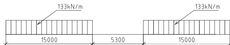
obr. 8 zaťažovací model SW/0 – v pozdĺžnom smere
