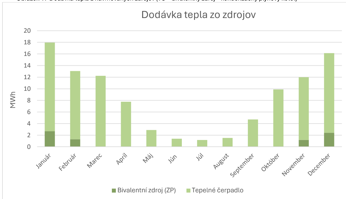
Obrázok 17 Dodávka tepla z navrhovaných zdrojov (TČ + bivalentný zdroj – kondenzačný plynový kotol)
