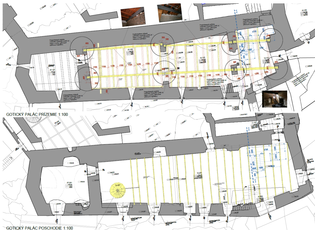
obr.08 Pôdorys prízemia a poschodia Gotického paláca, žltou prvky navrhnuté na odstránenie [1]
