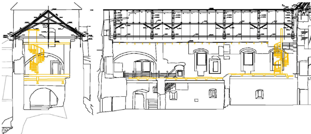
obr.09 Priečny a pozdĺžny rez Gotického paláca, žltou prvky navrhnuté na odstránenie
