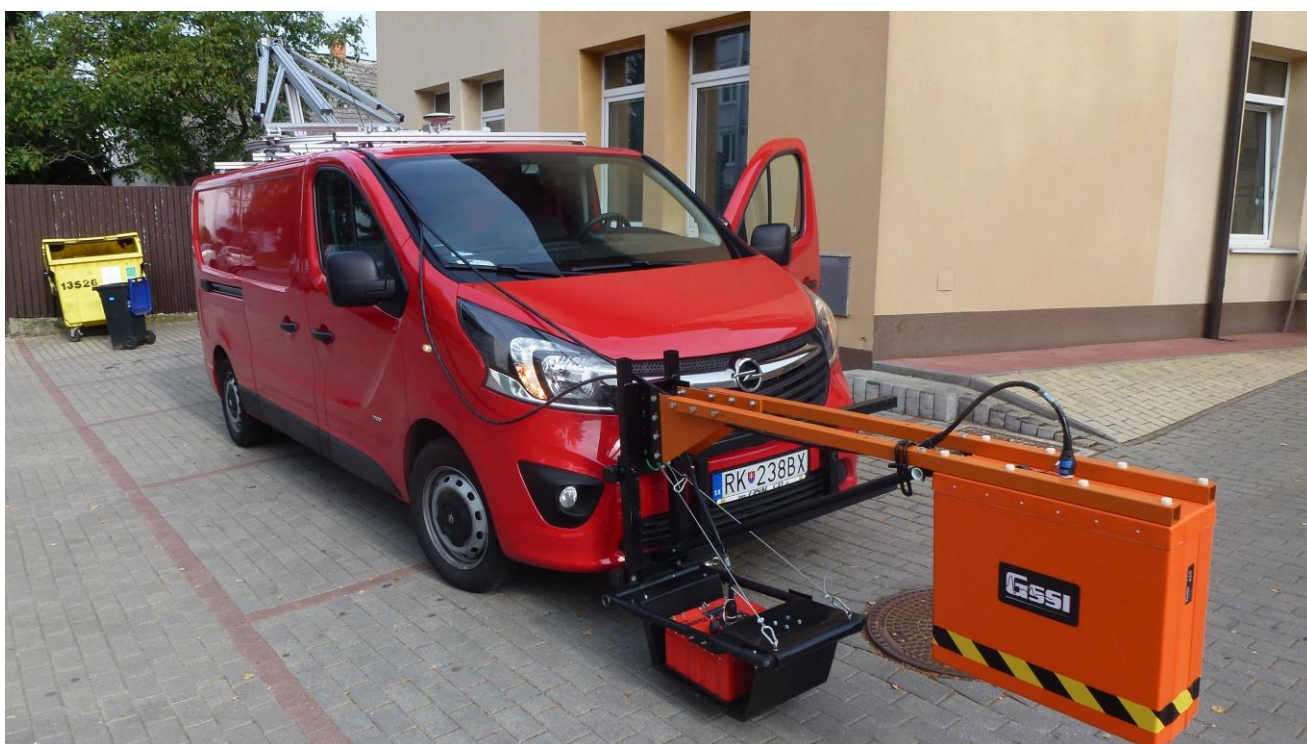
Obr. 1. GPR merací systém vybavený 2 GHz horn anténou a 400 MHz ground coupled anténou pred vozidlom. Videokamera s GPS anténou je upevnená na streche vozidla (oranžový box), laserový skener je nad povrchom meranej vozovky za meracím vozidlom.
