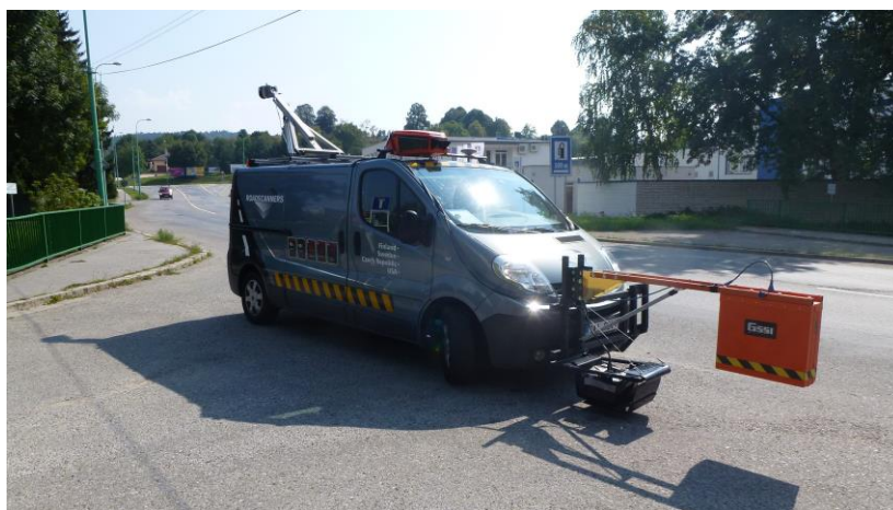
Obr. 1. GPR merací systém firmy Roadscanners Central Europe s.r.o vybavený 2 GHz horn anténou a 400 MHz ground coupled anténou pred vozidlom. Videokamera s GPS anténou je upevnená na streche vozidla (oranžový box), laserový skener je nad povrchom meranej vozovky za meracím vozidlom.
