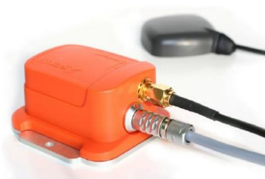
Obr. 4. Xsens MTi-G akcelerometer (oranžový) a gps-prijímač (čierny).
