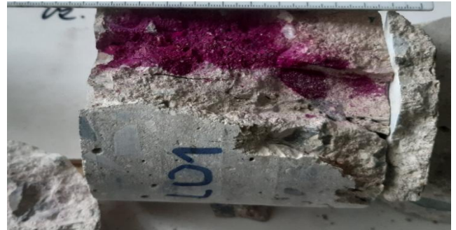
Obr. 2. Testovanie karbonatizácie - vnútorná časť vývrtu LO 1
