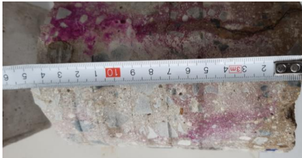
Obr.1 Posúdenie karbonatizácie vývrtu vz. LO 1 (vonkajší povrch)
