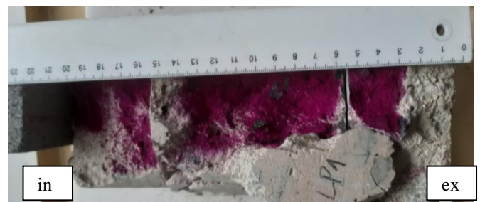
Obr. 4 Priebeh zmeny alkalickej reakcie, vnútorná časť vývrtu LP1
