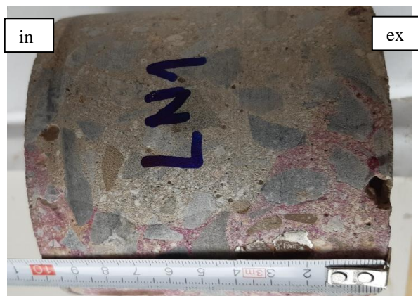
Obr.5 Posúdenie karbonatizácie vz. LN 1
