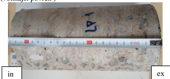
Obr.3 Posúdenie karbonatizácie vývrtu vz. LP 1 (vonkajší povrch)
