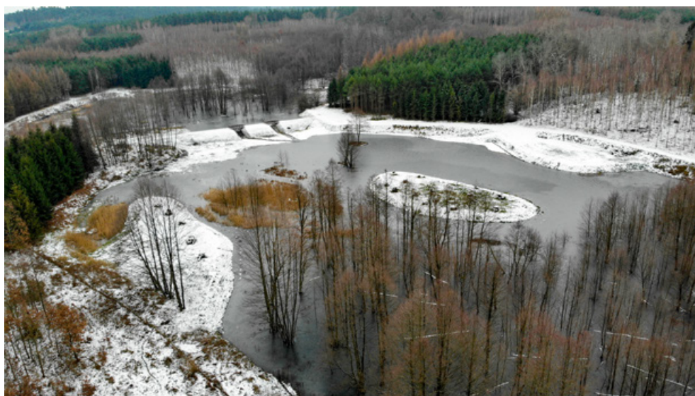
Fot. 9. Zbiornik z nieregularną linią brzegową, łagodnymi i ostrymi skarpami, przegłębieniami, wyspami z zacienieniem i nastonecznieniem brzegów w Nadleśnictwie Trzebciny (archiwum CKPŚ)
