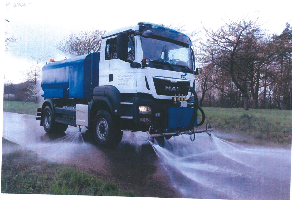
Nadstavba k podvozku B – Cisterna s postrekovou lištou
