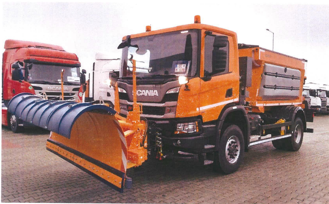
SCANIA P370, sypač EPOKE SH 3810 5m 3 , radlica ABM TECHNOLOGY PSV 290.4 Zákazník: NDS a.s. dodané 01/2020, počet ks- 1
