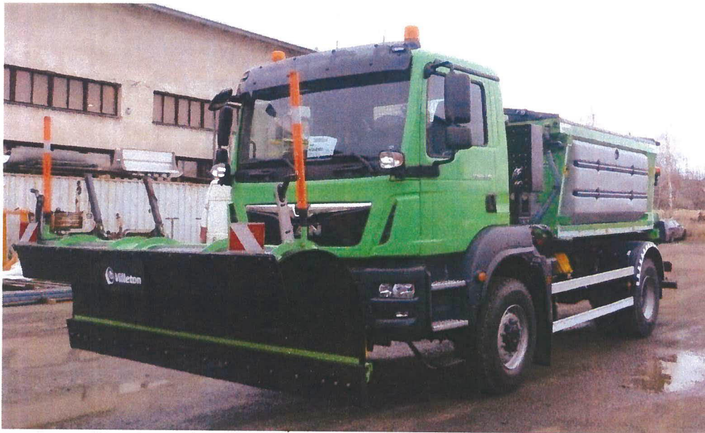
MAN TGM 18 320 4x4, sypač EPOKE SH 3810 4m 3 , radlica Villeton LR 3000 Zákazník: Begbie s.r.o., dodané 11/2020, počet ks- 2
