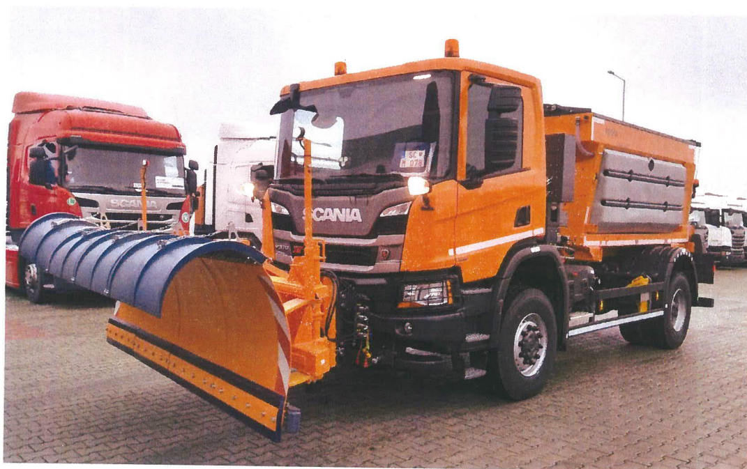
SCANIA P370, sypač EPOKE SH 3810 5m 3 , radlica ABM TECHNOLOGY PSV 290.4 Zákazník: NDS a.s. dodané 01/2020, počet ks- 1
