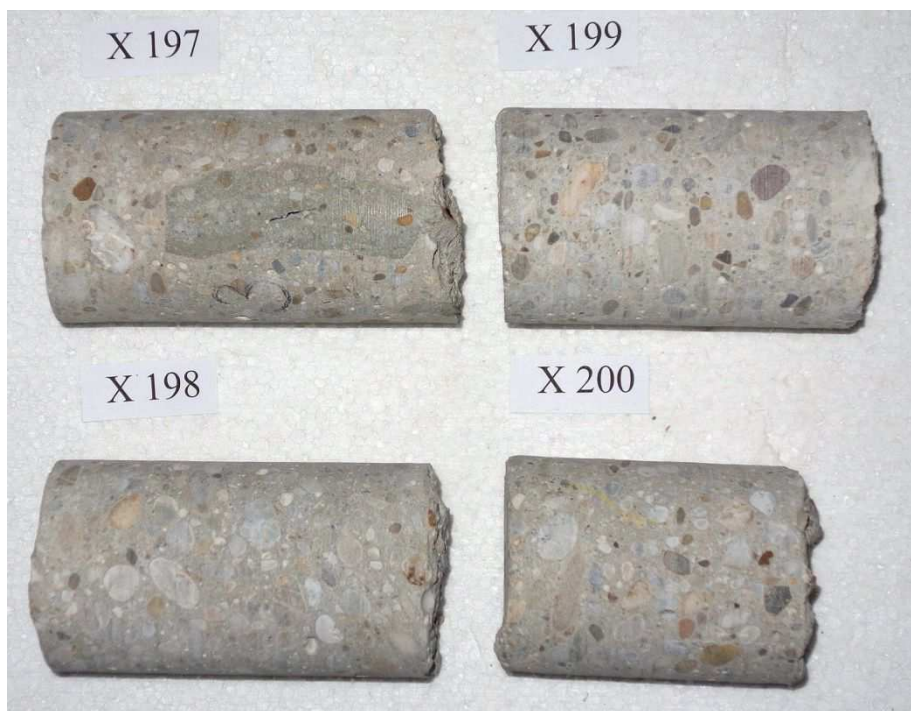
Obr. 1.: Vývrty z betonu po dodání do laboratoře
