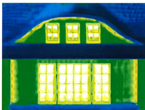
Po renovácii: energetické straty cez nové okná sú znížené na minimum (na obrázku: červená).
