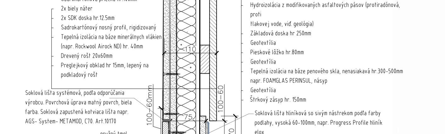
DETAIL "B" _zapusteného sokla M 1:5
