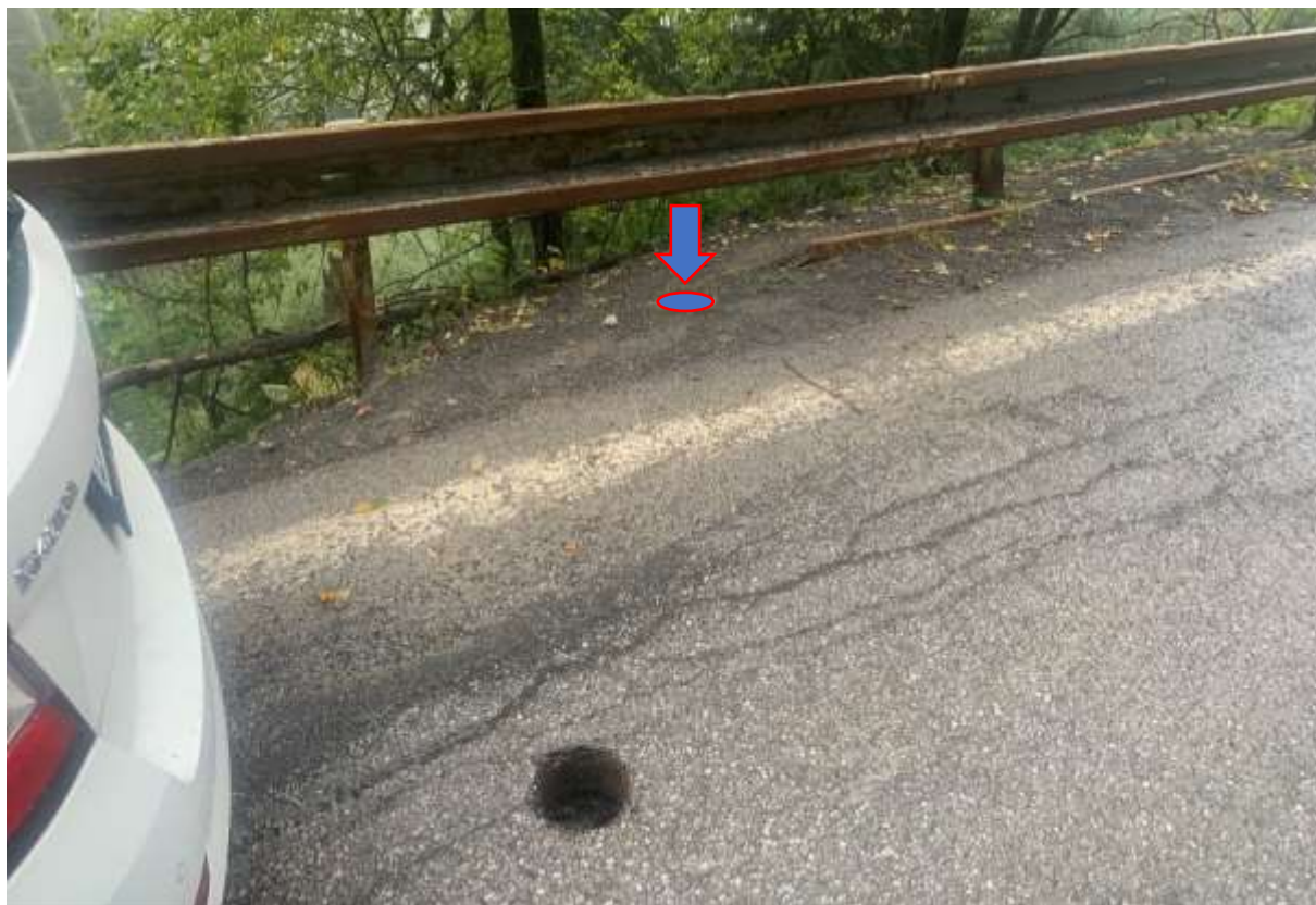
Obr. č. 5 DDD – 1, dynamická penetračná sonda
