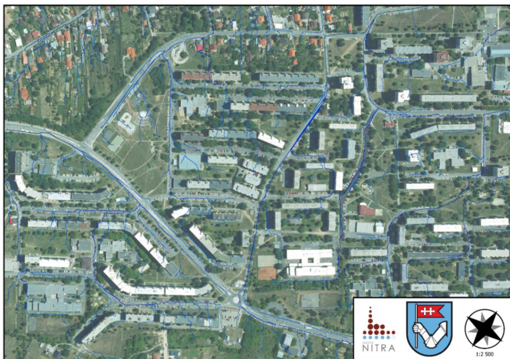
Obr. 10 Znáozornenie odtokových trás na záujmovom území mesta Nitra v časti sídliska Klokočina 2 časť
