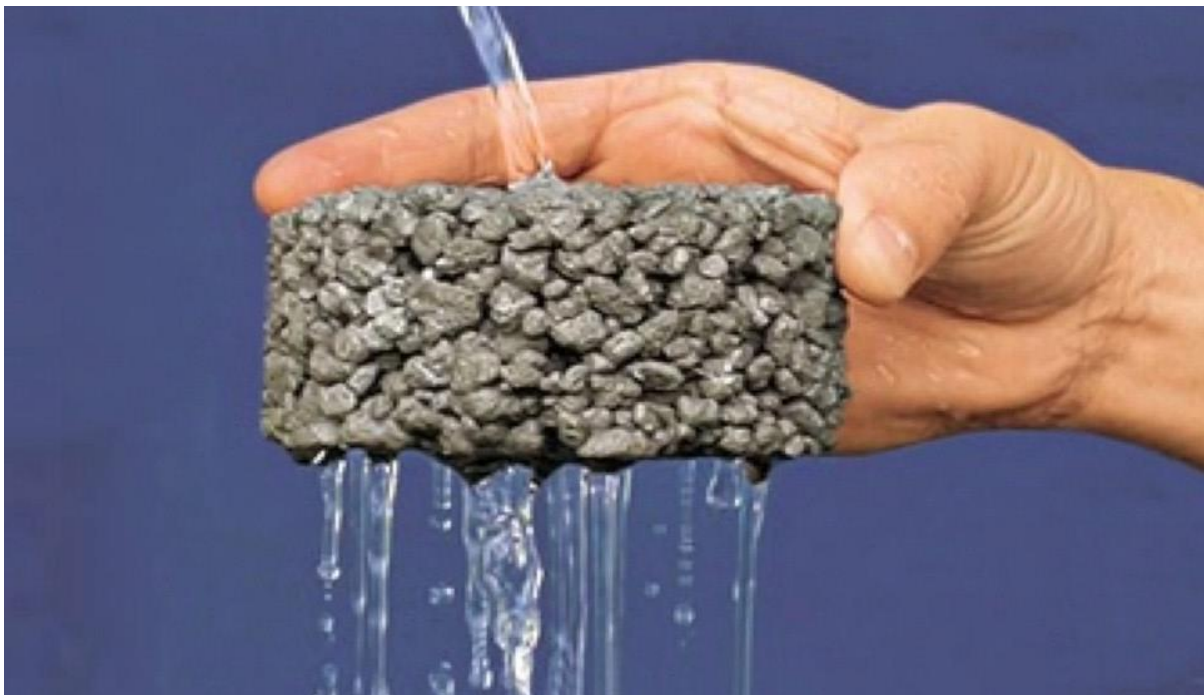
Obr. 24 porézny betón (asfalt)
