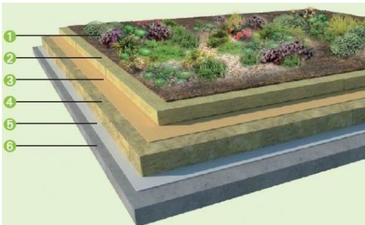
Obr. 39 Skladba extenzívnej zelenej strechy
