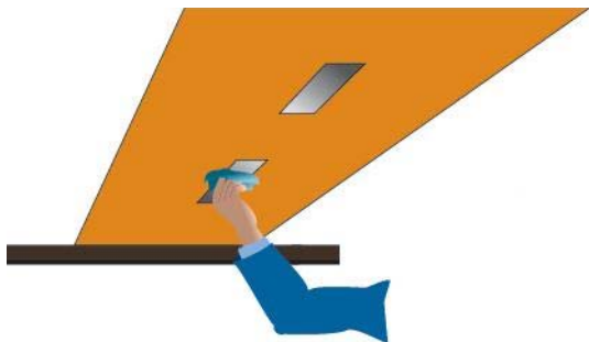
Obr. 24: Čistenie skleneného okna skenera
