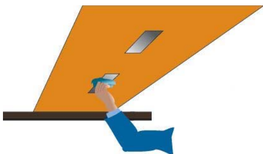
Obr. 82: Čistenie skleneného okna skenera
