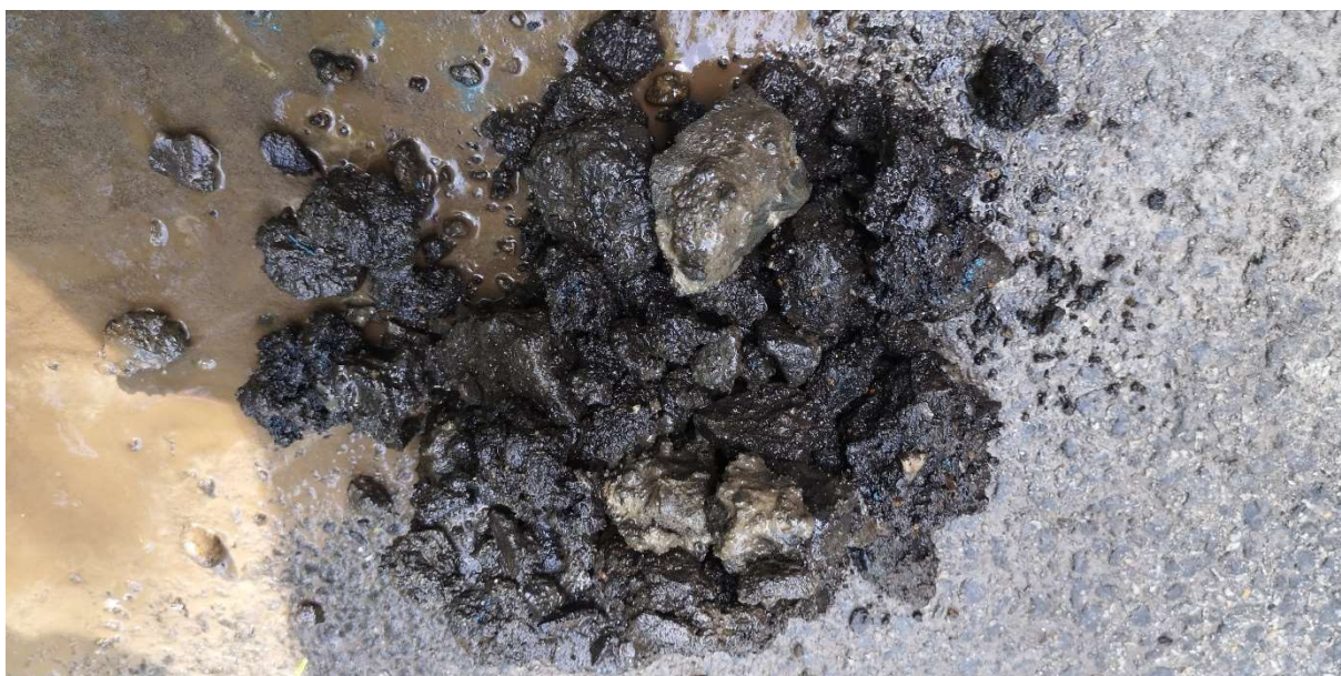
Obr. 8 Nestmelený materiál nachádzajúci sa pod asfalt. vrstvami
