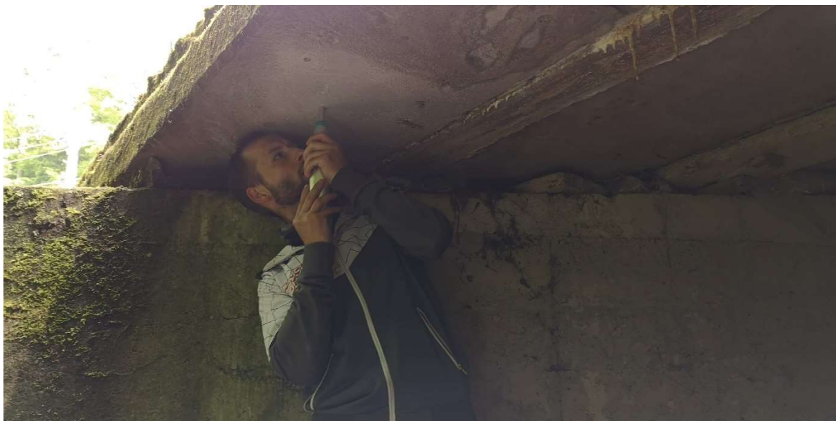
Obr 3. Schmidtov tvrdomer Proceq Original Schmidt typ N
