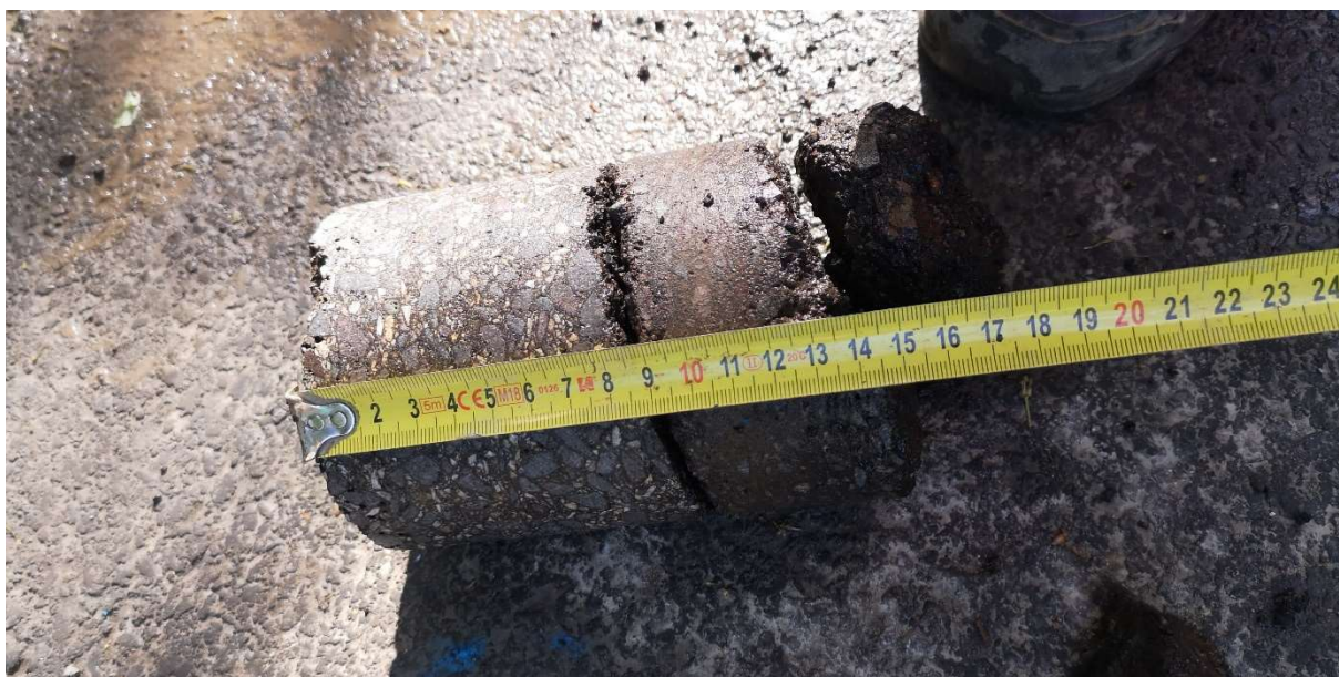
Obr. 6 Stmelené asfaltové vrstvy
