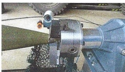
Upevnění zapalovače do vřeteníku MOZ-2M
