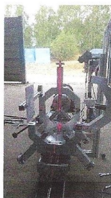
Upevnění zapalovače do vřeteníku MOZ-2M
