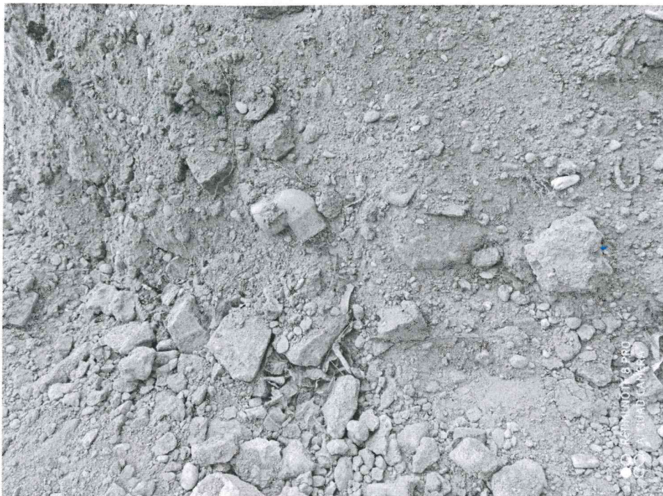
Obr. č.2 – nájdený stavebný odpad pod terajšou podlahou
