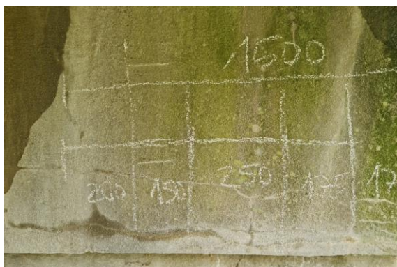
Obr. 68 Nedeštruktívne zisťovanie polohy výstuže
