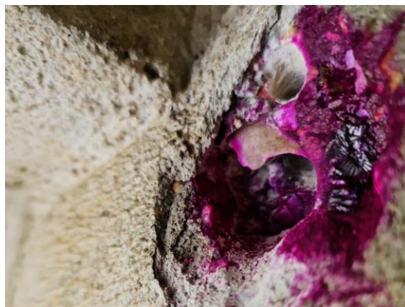
Obr. 53 Fenolftaleínová skúška na nosníku
