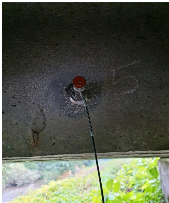
Obr. 50 Realizácia odtrhovej skúšky
