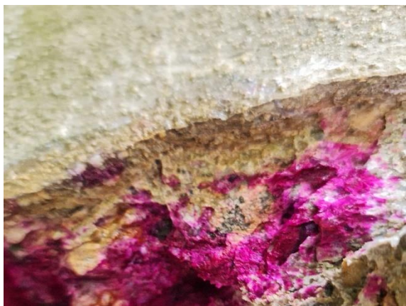
Obr. 52 Fenolftaleínová skúška na úložnom prahu
