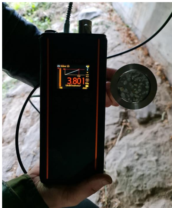
Obr. 51 Pohľad na prístroj a odtrhnutý terčik
