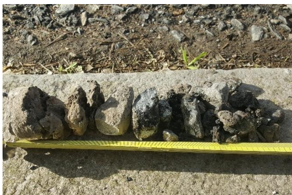
Obr. 48 Meranie zloženie vývrtu z vozovky
