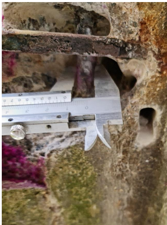
Obr. 67 Meranie priemerov výstuže v sonde S1
