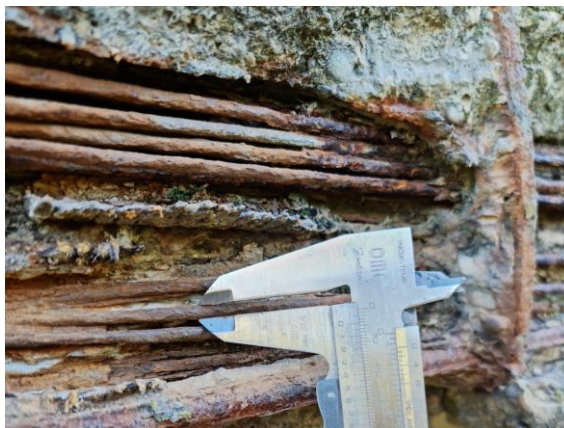
Obr. 75 Meranie priemerov drôtov predpätej výstuže
