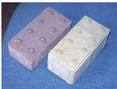
Obr. 1 Betonová zámková dlažba s výstupky pravidelného tvaru
