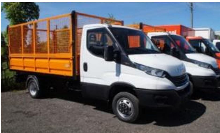
Samochód wyposażony w burty częściowo pełne oraz częściowo przezierne
