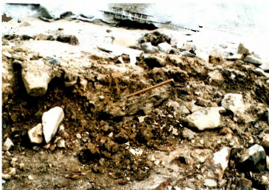
obr. č.6 Na plate odkopu zreteľná vrstevnatosť laminovaných až tenkodoskovitých ílovcov
