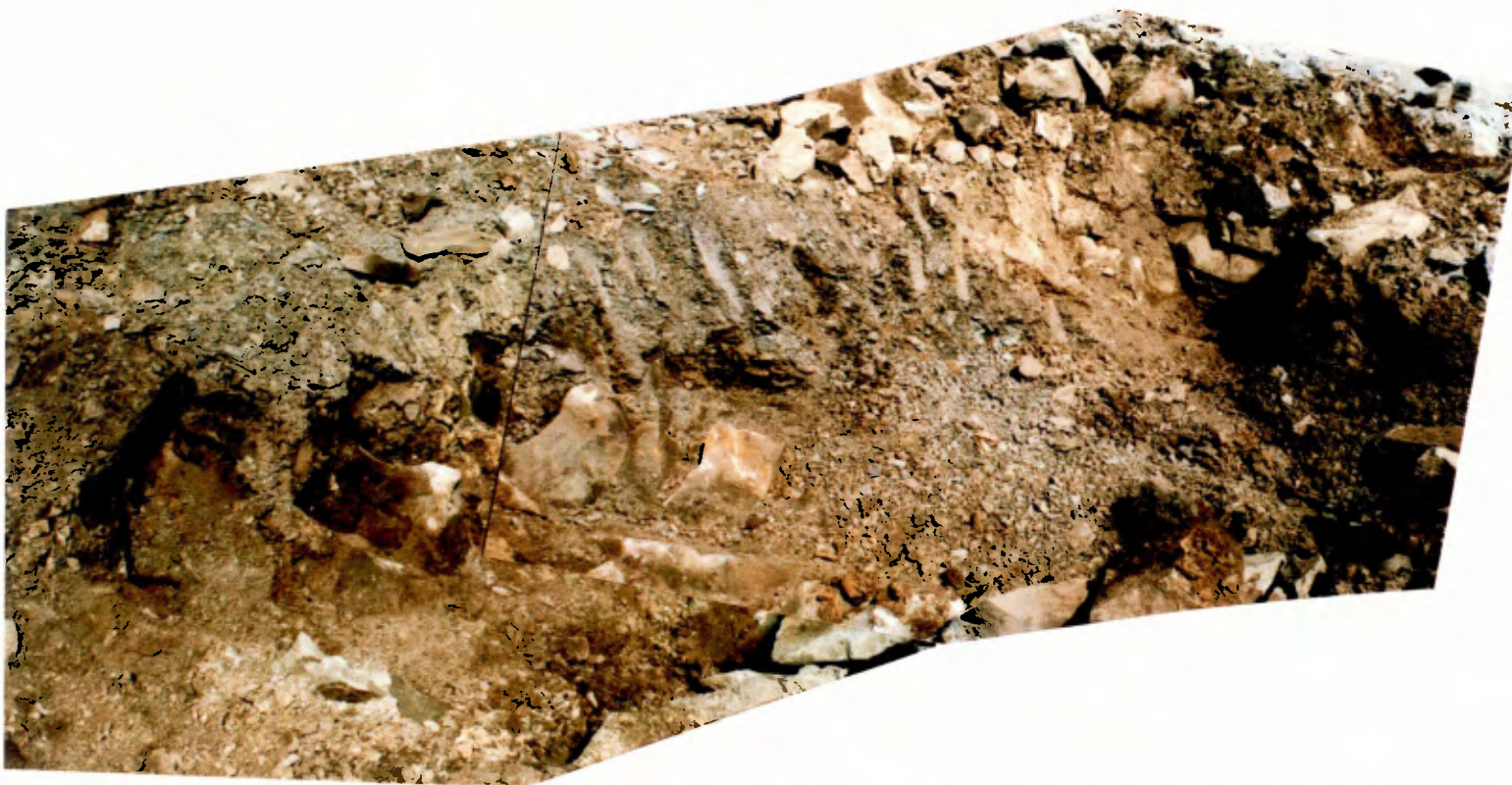
obr. č.10 Vrstva ílovcov medzi doskovitými až lavicovitými pieskovcami v prieskumnej rýhe situovanej v smere priečneho geofyzikálneho profilu
