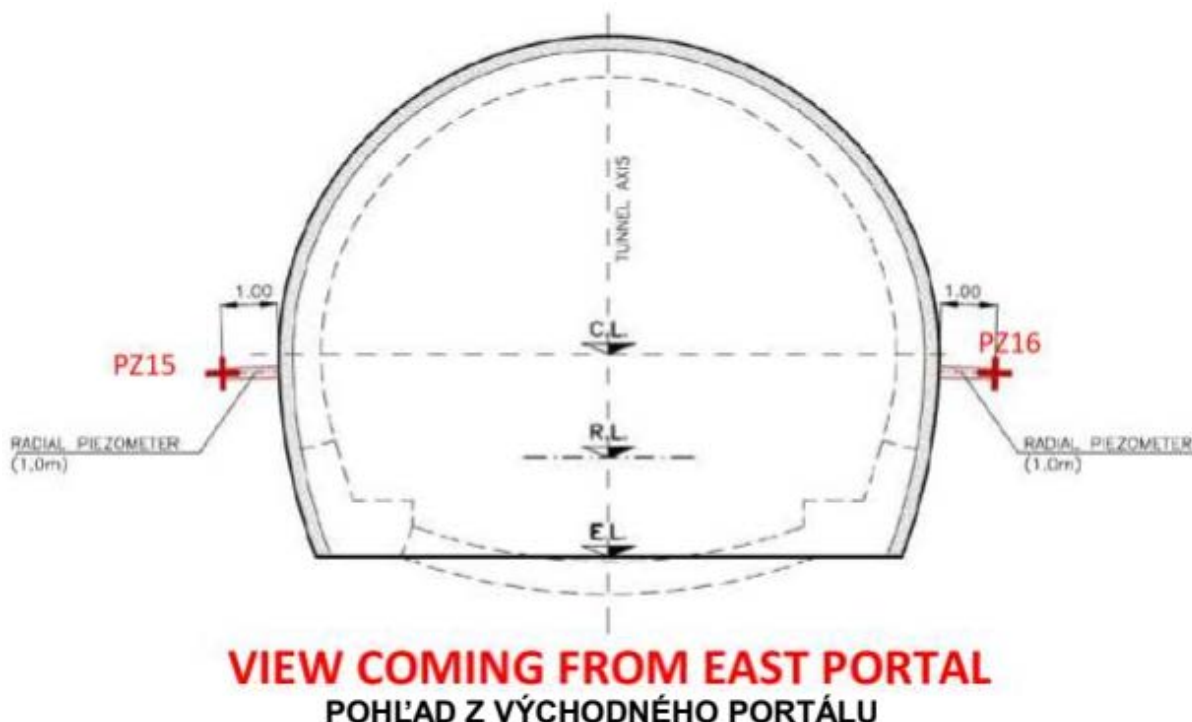
Obr. 29 Schéma HMP 3SE – PZ / dvojica radiálnych piezometrov
