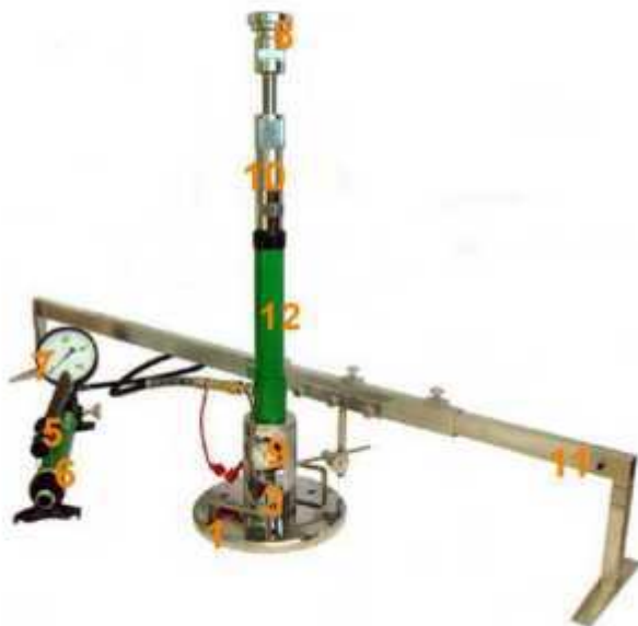
Rys. 1.2 Aparatura VSS z jednopunktowym pomiarem przemieszczenia płyty
