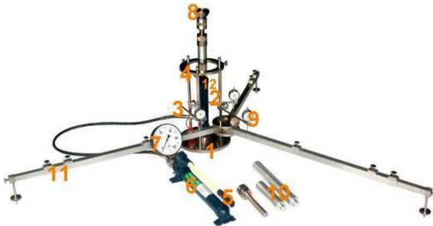
Rys. 1.1. Aparatura VSS z trzypunktowym pomiarem przemieszczenia płyty
