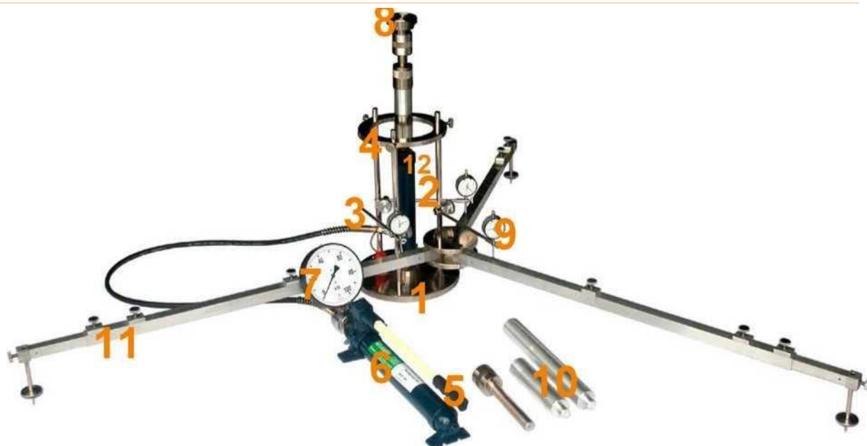
Rys. 1.1. Aparatura VSS z trzypunktowym pomiarem przemieszczenia płyty
