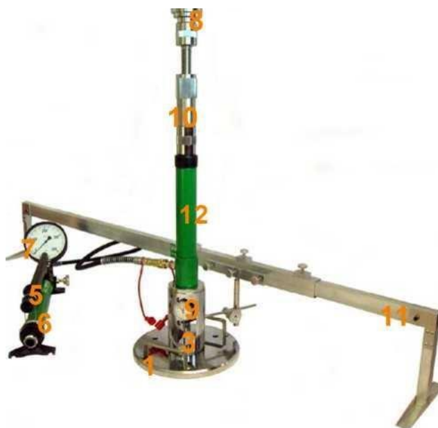
Rys. 1.2. Aparatura VSS z jednopunktowym pomiarem przemieszczenia płyty
