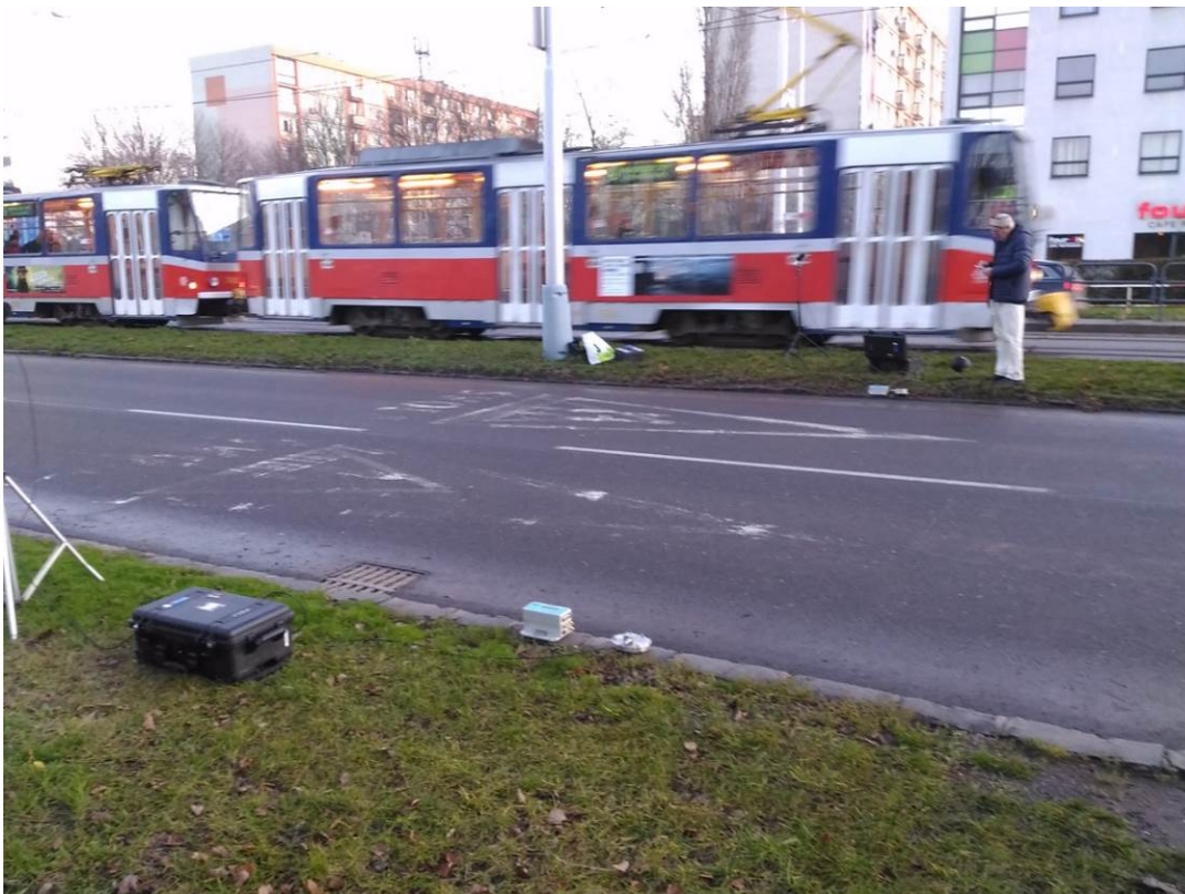
Obr. NI 19 Meracie stanovisko pri meraní hluku a vibrácii na nezmodernizovanej električkovej trati vo vzdialenosti 12 m od električkovej trate.
