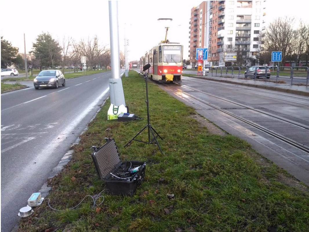
Obr. NI 19 Meracie stanovisko pri meraní hluku a vibrácii na nezmodernizovanej električkovej trati vo vzdialenosti 12 m od električkovej trate.
