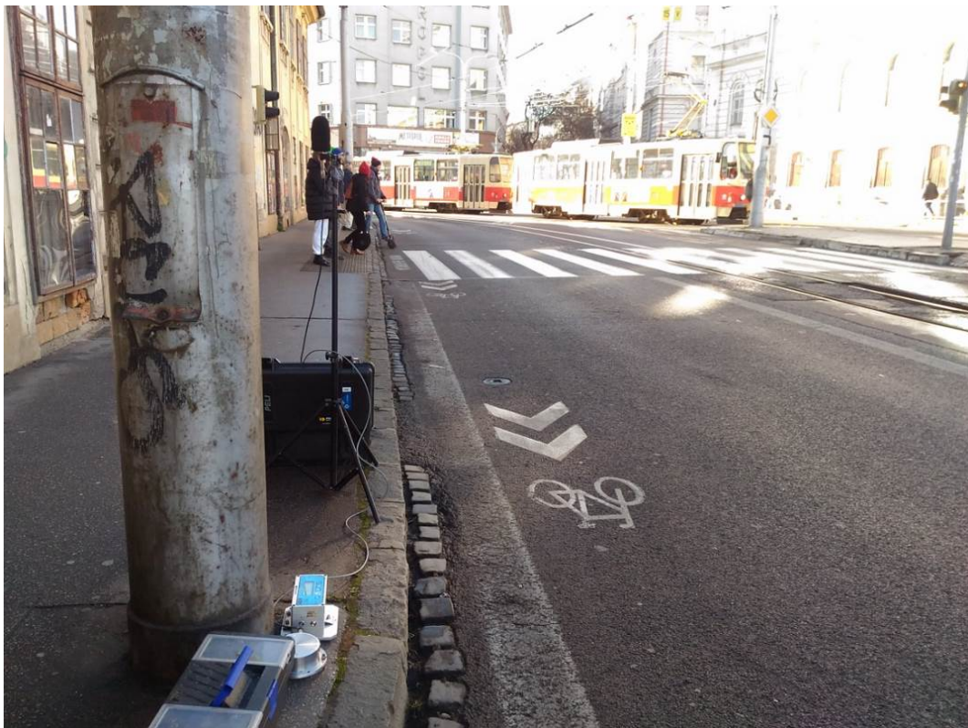
Obr. NI 9 Americké námestie v Bratislave. Pohľad na meracie stanovisko pri meraní hluku a vibrácií na nezmodernizovanej električkovej trati pred budovou dekanátu Lekárskej fakulty Univerzity Komenského.
