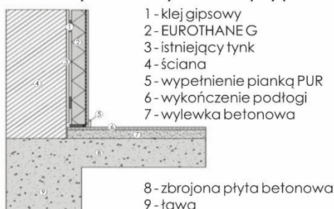
Rysunek 3 - Połączenie ściany i sufitu
