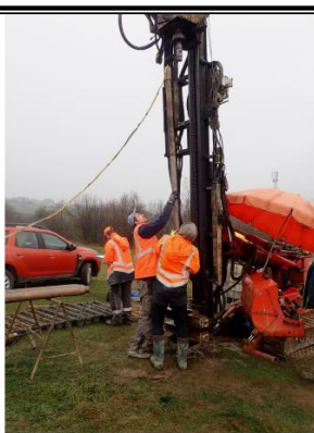
Vkladanie dilatometrickej sondy do vrtu IN-10-01
