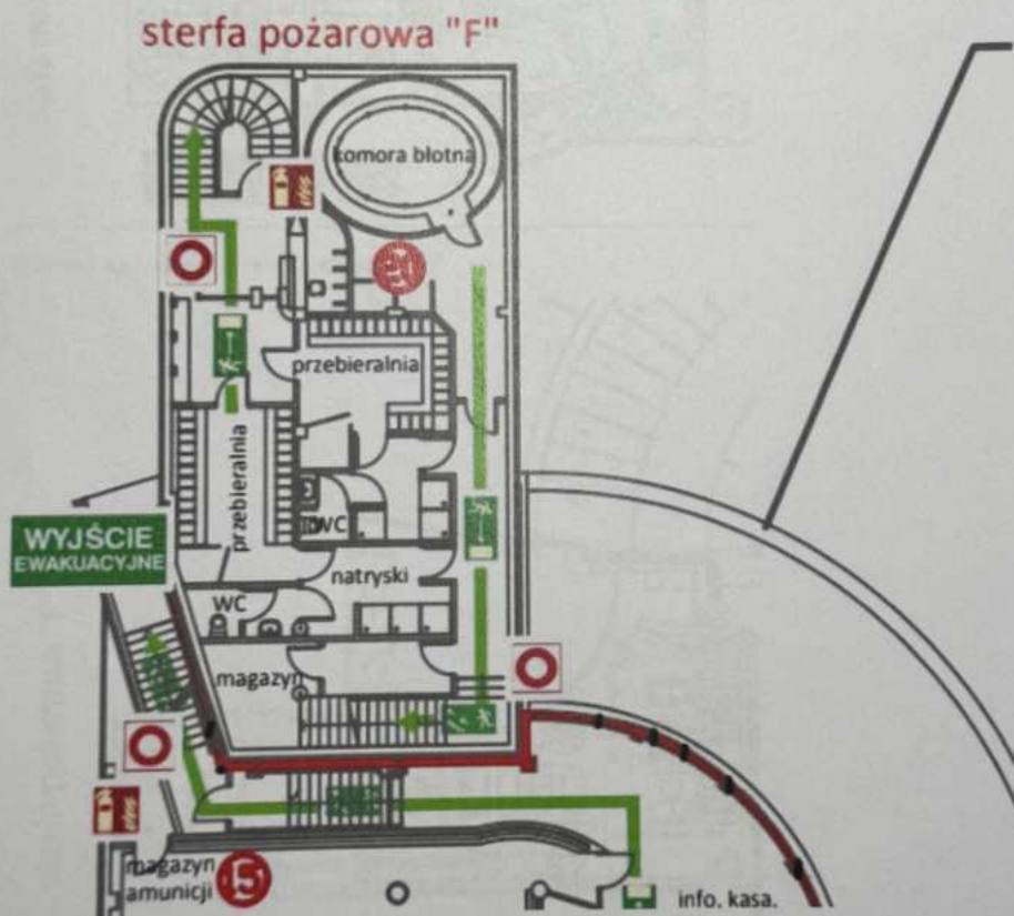
Rysunek 1. Rzut poziomy -1 – strefa pożarowa F
