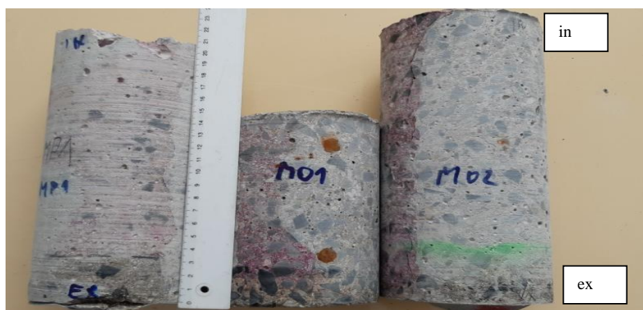
obr.1 Odbery MP 1, MO 1 MO 2 , Most Hlinková, testovanie karbonatizácie – vonkajší povrch
