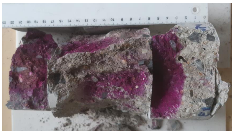
Obr.4 Posúdenie karbonatizácie, vnútrojšok vývrtu vz. MP 1
