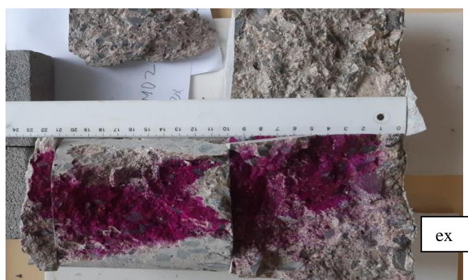
Obr. 3. Testovanie karbonatizácie - vnútorná časť vývrtu MO2
