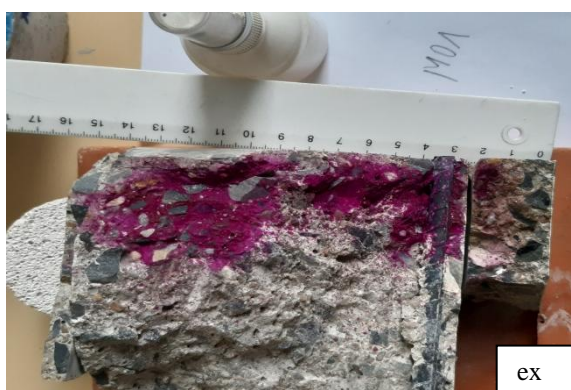
Obr. 2. Testovanie karbonatizácie - vnútrojšok vývrtu MO1
