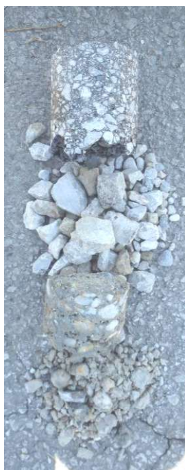
Obr. 7 Vrt č. 3 vo vozovke miestnej komunikácie
