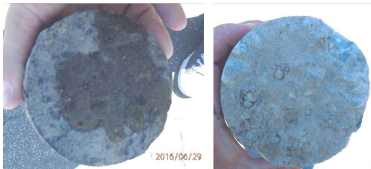
Obr. 6 Nedokonalé spojenie jednotlivých vrstiev vozovky na mostnom objekte
