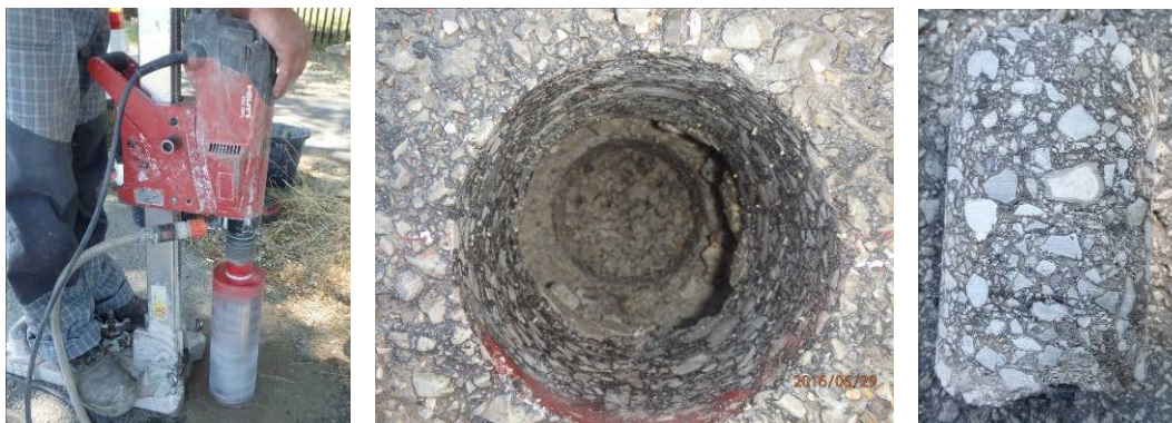
Obr. 2 Odber jadrových vývrtov z miestnej komunikácie
